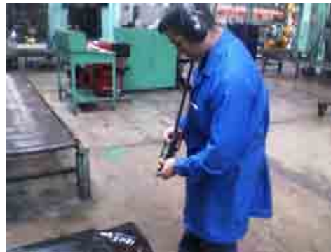
Pruebas de ruido con estetoscopio electrónico
