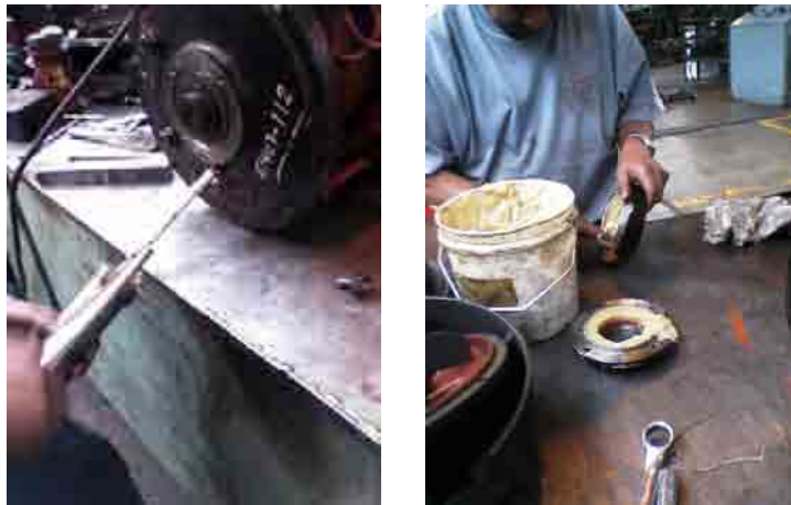
Grasa aplicada a los rodamientos
