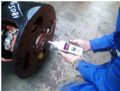
Prueba de rpm con tacómetro electrónico
