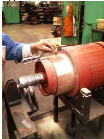
Rebajado de mica con sierra
