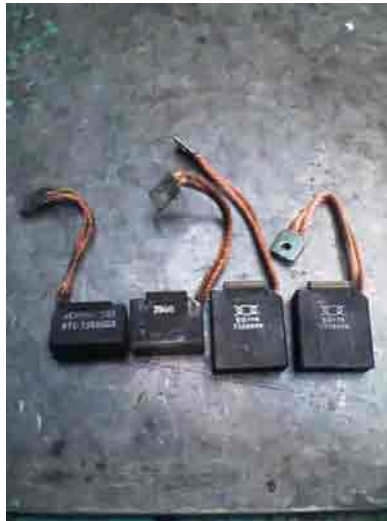
Se puede observar claramente el desgaste de los carbones de la izquierda y los nuevos carbones a la derecha
