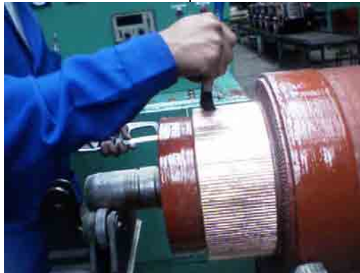
Limpieza de conmutador
