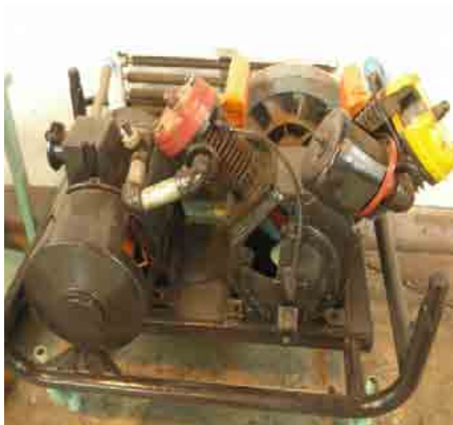
Conjunto completo de Moto-compresor
