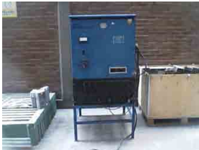
Banco de descarga
