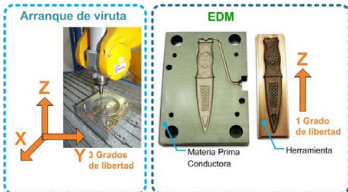
▲ Figura 1.2. Diferencia de los grados de libertad necesarios entre maquinado por arranque de viruta y EDM.
