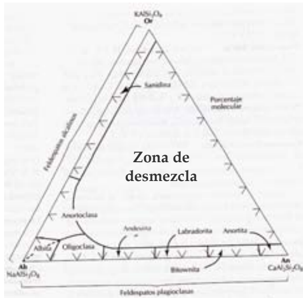
Fig. 6. Nomenclatura de la serie de los feldespatos plagioclasas y de los feldespatos alcalinos de alta temperatura (Tomando de Klein & Hurlbut, 1998, Manual de mineralogía, Editorial Reverté, pp. 590).
