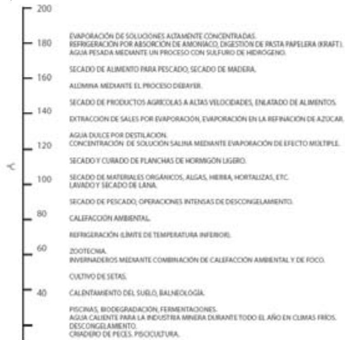
Fig. 3. Temperatura aproximada de los fluidos geotérmicos para su utilización como usos directos (Lindal, 1973).
