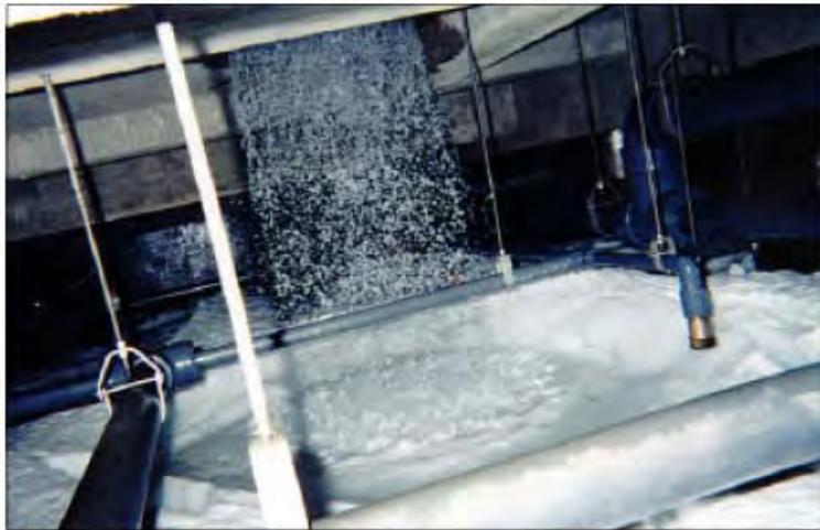
**Figura 1.1.** Hielo fluido en un tanque de almacenamiento [7].
