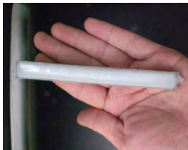
Figura IV.2 Pieza obtenida de inyección para prueba de impacto.
