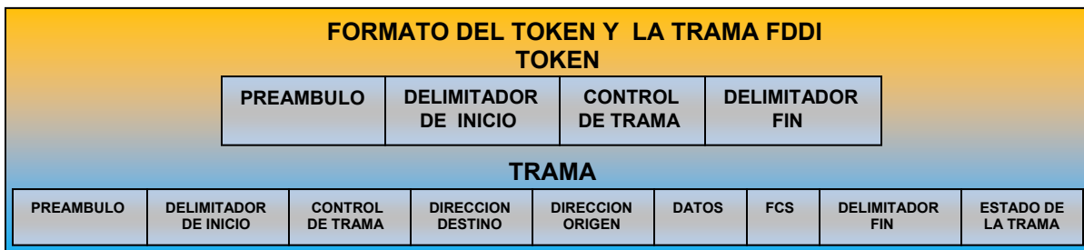
Figura 143 Formato del a) Token FDDI b) trama FDDI
