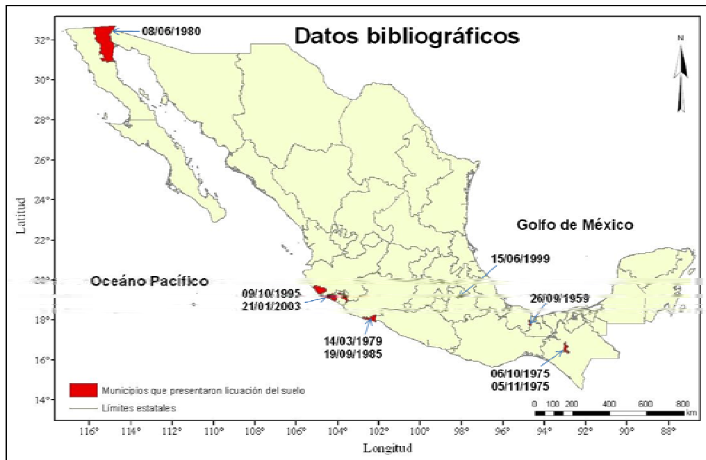
Figura 4.3 Mapa de municipios en los que se ha presentado licuación del suelo (tabla 4.1), datos obtenidos a partir de bibliografía.
