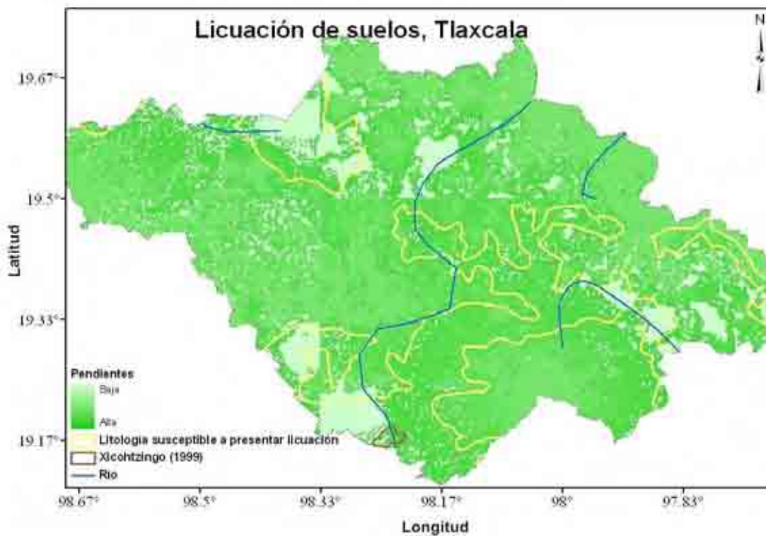
Figura 4.9 Mapa de datos bibliográficos, litología y pendientes de la zona de Tlaxcala
