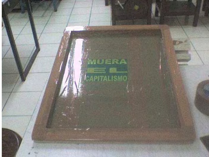
Figura 4.23 Imagen que muestra el encamisado de un estencil
