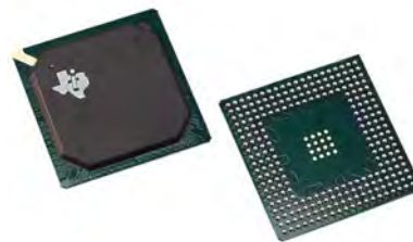
Figura 1.12 15 Ejemplo de empaquetado BGA
