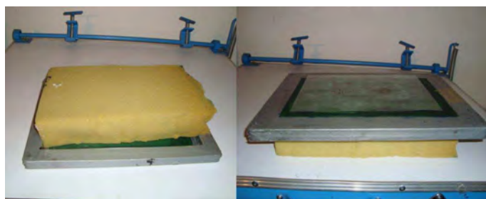
Figura 4.28 Arreglo para insolar con la luz del sol
