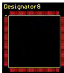
Figura 4.18 Ejemplo del footprint para el F2812
