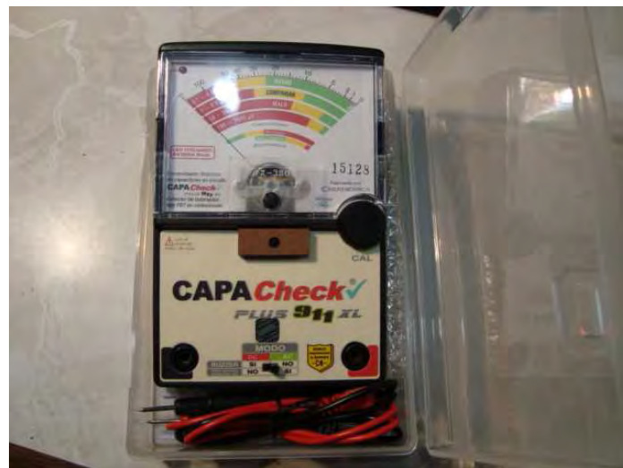
Figura 2.18 CAPACheck Plus 911 de la firma Creatronica (medidor de ESR)
