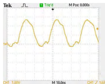
Figura 6.2 Forma de onda de la señal de reloj que llega al DSP
