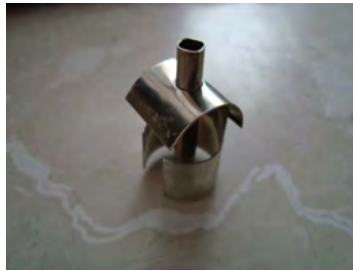
Figura 4.37 Boquilla de aire recomendada para la 6966C
