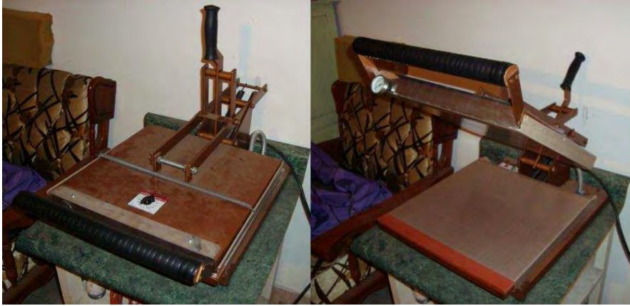
Figura 4.16 Plancha serigráfica o plancha transfer
