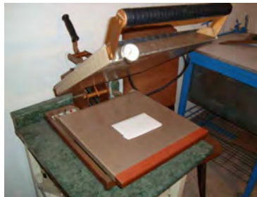
Figura 4.32 Colocación de la placa forrada en la plancha transfer
