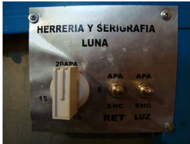
Figura 4.10 Mandos de la mesa multi-usos de la figura 4.6 en donde se aprecia (izquierda) el cronómetro para controlar el tiempo de exposición
