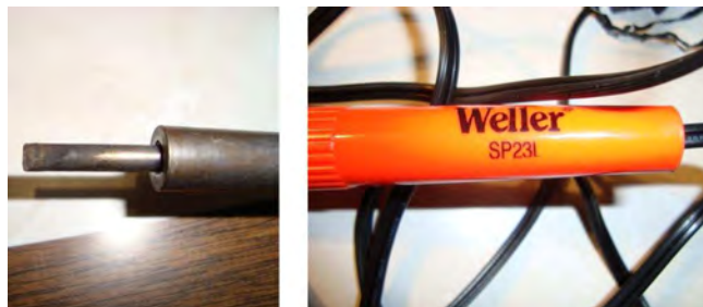
Figura 4.33 Cautín Weller modelo SP23L y su punta plana
