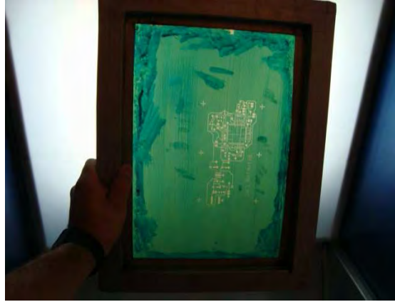
Figura 4.12 Verificando un estencil en la tina de revelado
