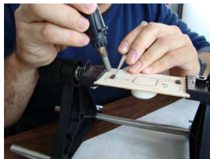
Figura 4.43 Remoción de un componente superficial
