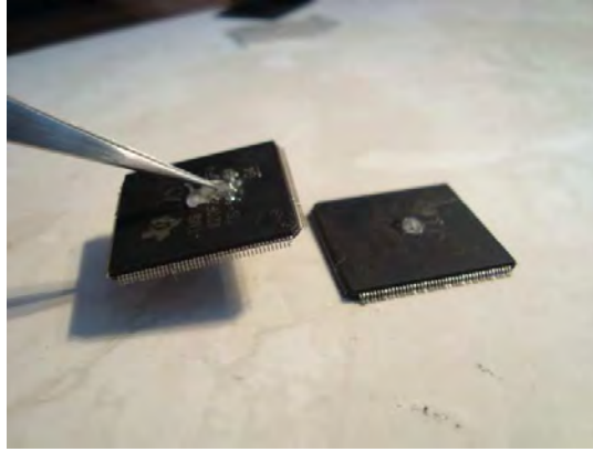
Figura 4.41 Poner una gota de silicón sobre el componente para manipularlo fácilmente con las pinzotas
