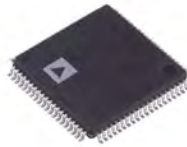
Figura 1.11 13 Ejemplo de empaquetado QFP
