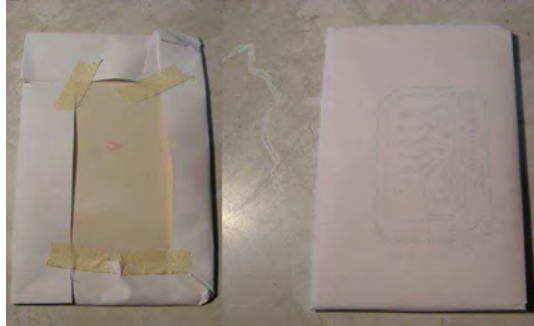
Figura 4.31 Forrado de la placa fenólica antes de plancharla
