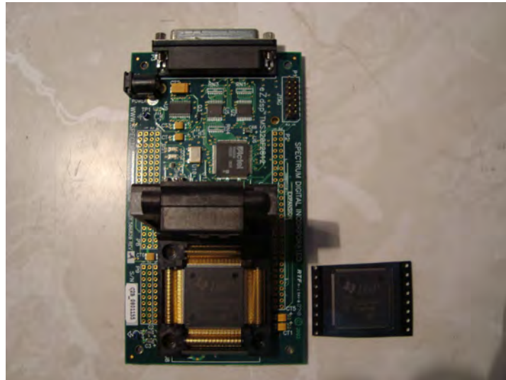
Figura 1.23 Módulo eZdsp para el DSP TMS320F2812
