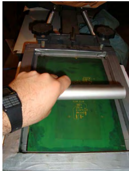
Figura 4.24 Ajuste del estencil al brazo del pulpo y verificación del tamaño del rasero
