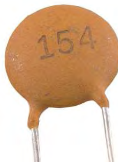
Figura 2.16 33 Capacitor cerámico común (conocido como capacitor “de lenteja”)
