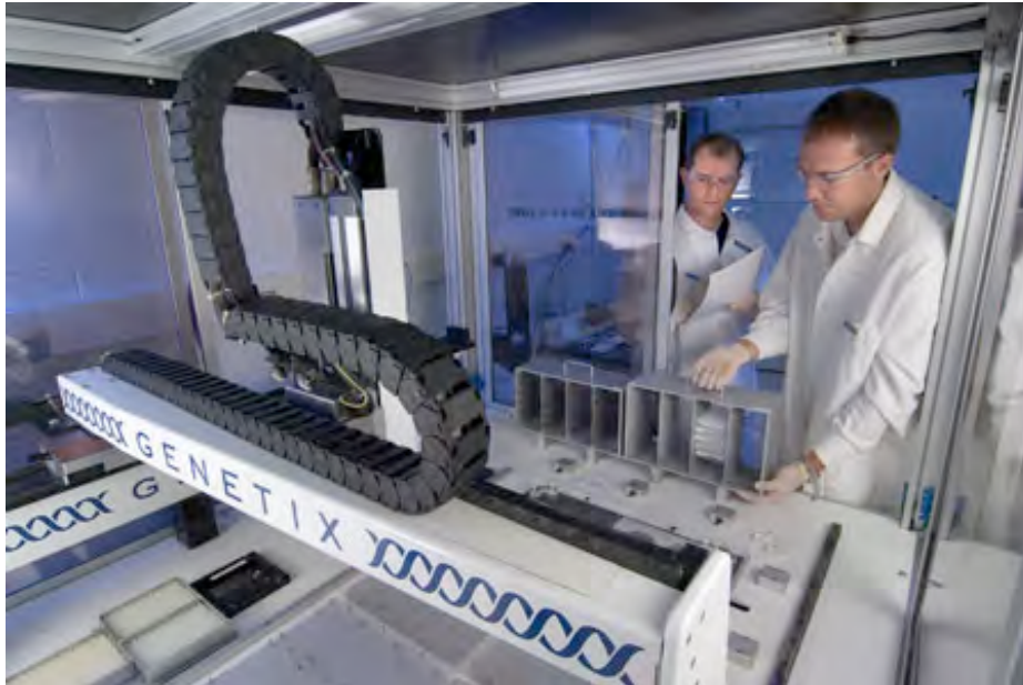
Figura 4.4. Robot de microarreglos de la marca Genetix similar al que existe en el laboratorio de Davidson en Caltech. El “martillo” tiene la capacidad de automatizar por completo los procesos que requieran hacerse con un alto rendimiento. El sistema puede purificar y normalizar 800 plásmidos en aproximadamente seis horas.
