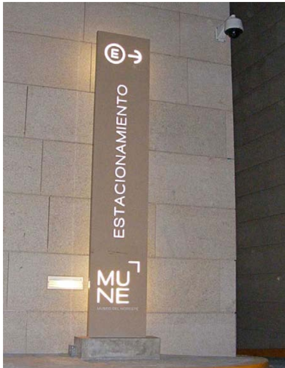
Fig. 28. Señal direccional, de panel, iluminada por atrás con luz de tungsteno, para el Museo del Noroeste, en Nuevo León.
