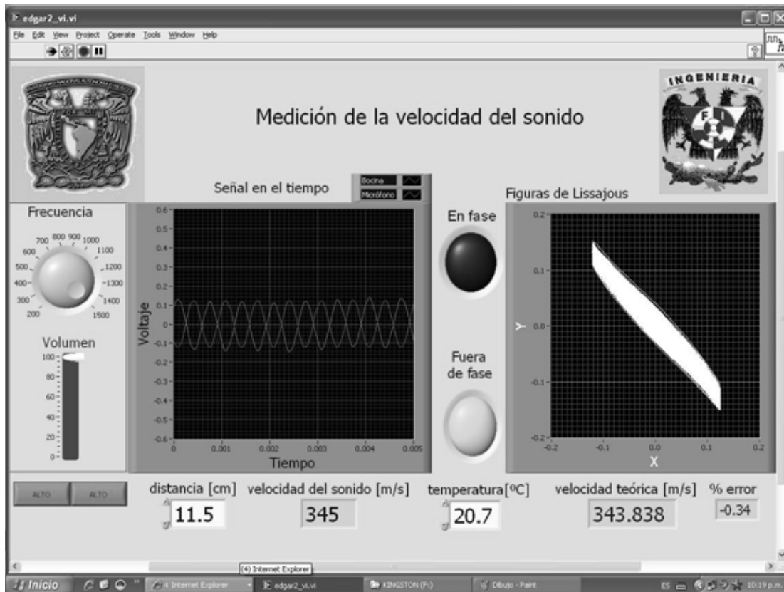
Figura g). Aspecto de la interfaz con todos los datos y el cálculo de la velocidad del sonido
