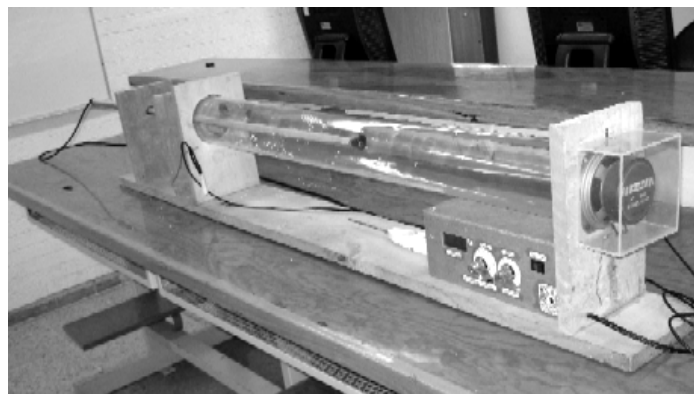
Figura 21a. Prototipo (Variación del tubo de Kundt)
