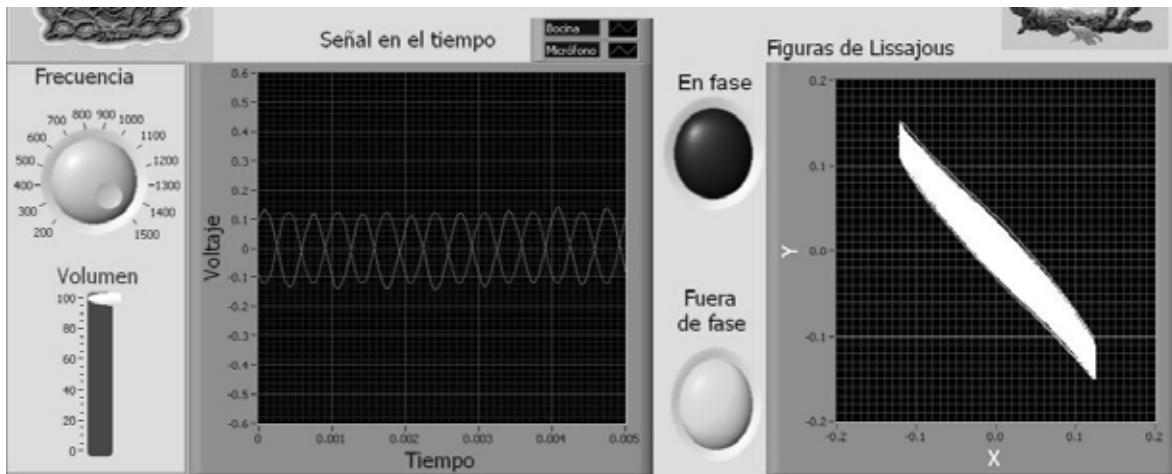
Figura e). Ondas fuera de fase (desfasamiento de 180 grados)
