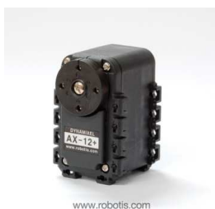
Figura 2.3.1 servomotor Dynamixel AX-12+ utilizado
