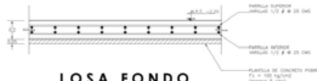
LOSA FONDO CISTERNA
