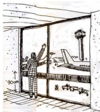
Fig. III-16. Protección con manguetas y barandales en ventanas de piso a techo.
