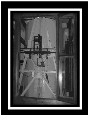
Sismógrafo mecánico Wiechert, data de 1910 Imagen: Archivo SSN
