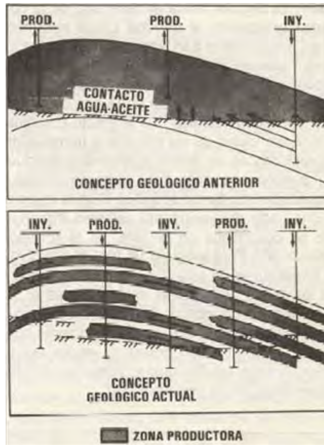
Figura 4-6. Comparación entre un concepto geológico típico y un concepto geológico con unidades de flujo
