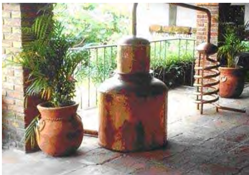
Figura 7. Campana y serpentín del alambique
