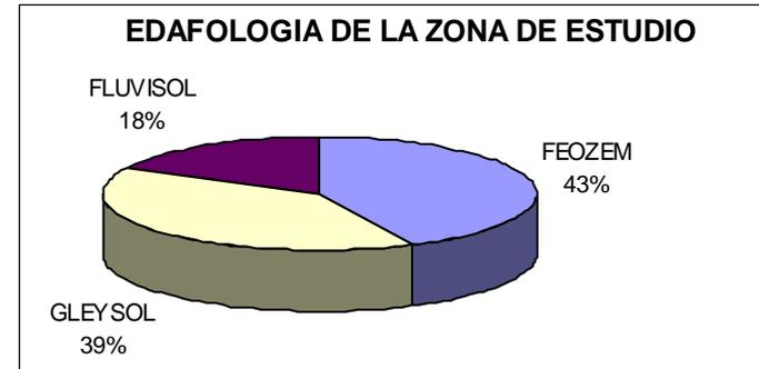
Toda el área que conforma el poblado de Mixquic es de tipo Gley, lo que significa que esta impregnado de agua durante largos períodos, los que lo hace inapropiado para construcciones, ya que en algunas zonas existen hundimientos en las estructuras, previniendo esto, las construcciones que recientemente se elaboraron, y que tiene un alto nivel de seguridad, hacen sustitución de suelo, y es mas común ver losas de cimentación.
