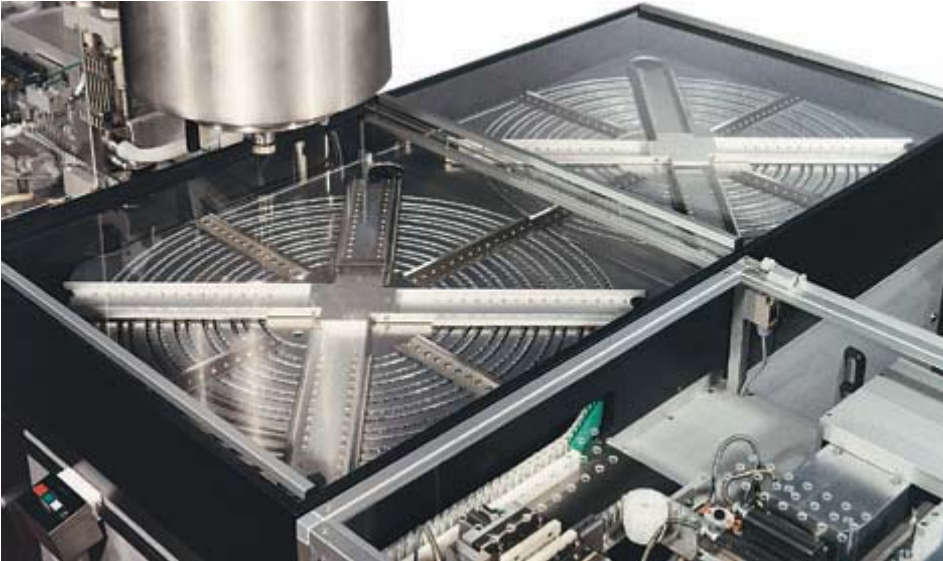
Fig. 18 Estación de enfriamiento (de http://www.sarong.it/ )
