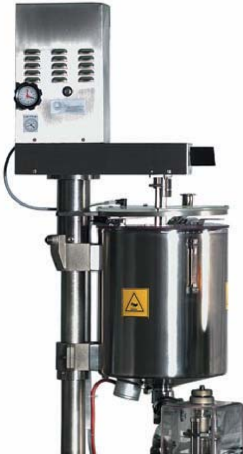
Fig. 10 Tanque de producción del equipo SSA 2 (de http://www.sarong.it/ )
