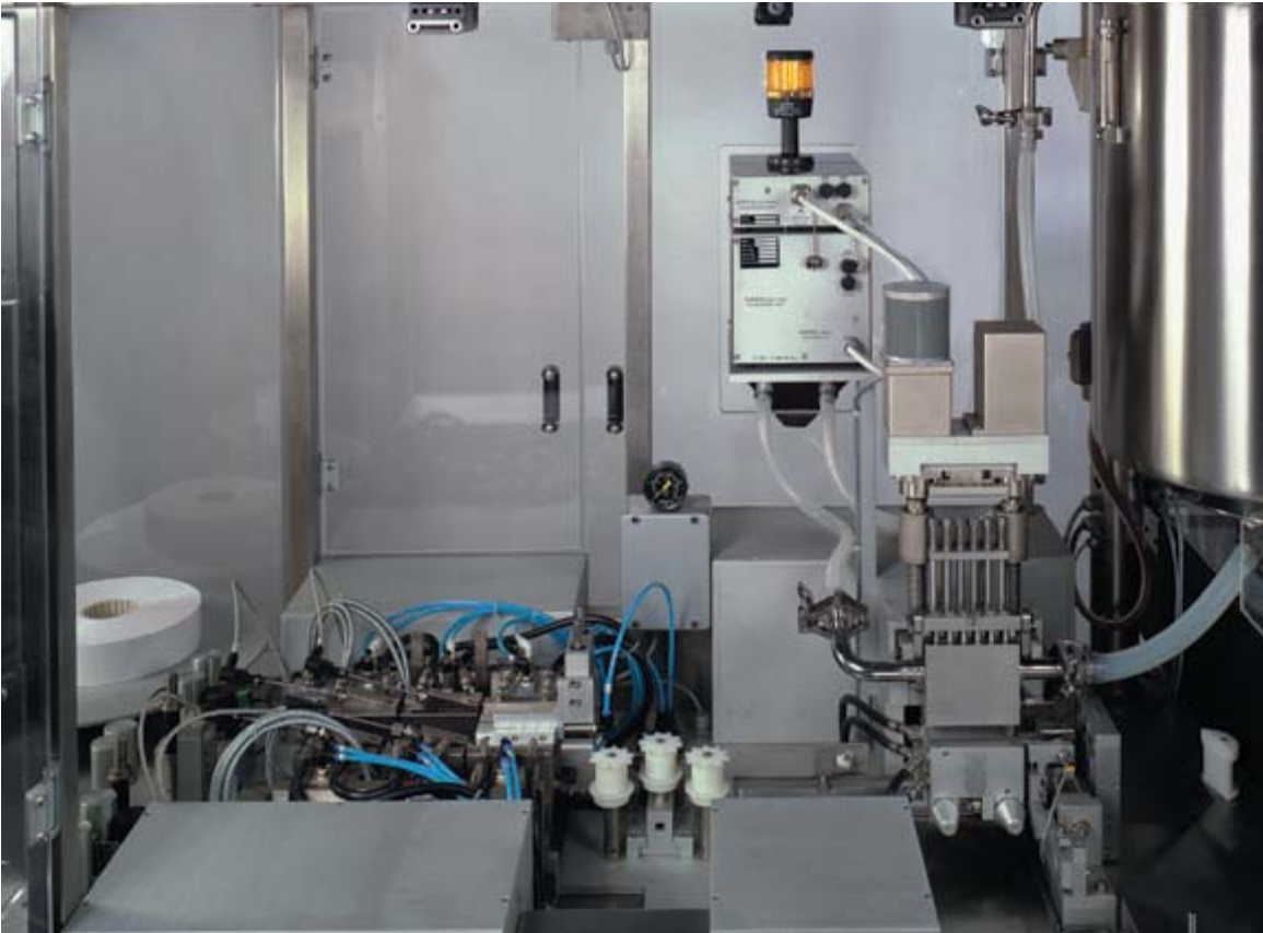
Fig. 17 Estación de termoformado y de llenado ( de http://www.sarong.it/ ) En la figura se observa la estación de termoformado y las máquinas inyectoras.
