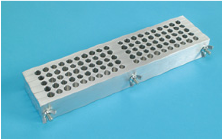
Fig. 7 Molde para la fabricación de supositorios (de www.fimma.net/Moldes.htm )
