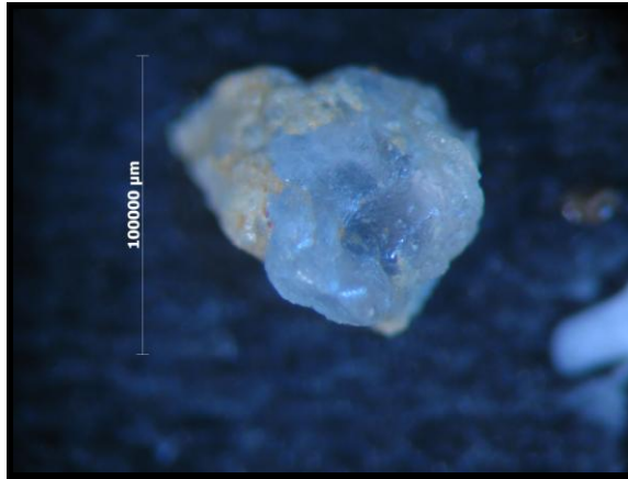
Fotomicrografía 22. Esferulita que presenta una forma a manera de racimo de uvas, esta esferulita está compuesta de otras más pequeñas, las cuales se confirman de manera común con el microscopio petrográfico.
