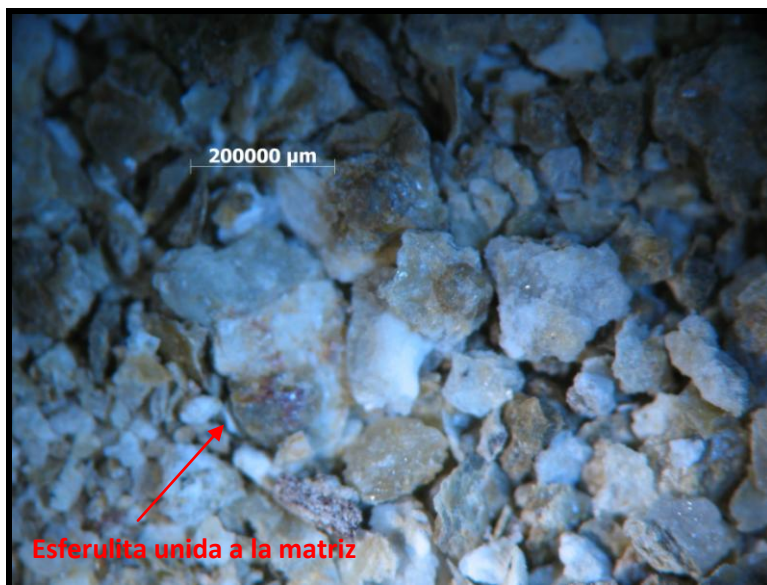
Fotomicrografía 21. Esferulitas en conjunto con la matriz arcillosa y carbonatada en El Mimbral.
