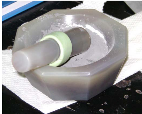
Figura 12. Mortero de ágata de diámetro de 6 cm, empleado para la preparación de muestras de
