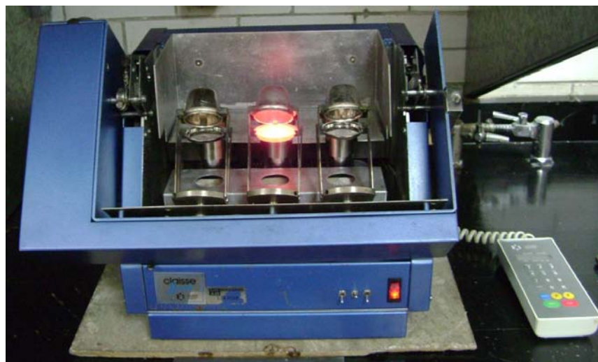
Figura 15. Instrumento para fundir muestras automáticamente, marca Claisi, Fluxi., con la muestra en fundido total.
