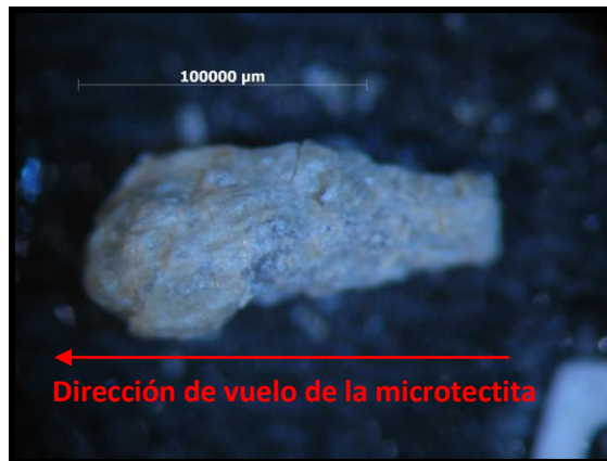
Fotomicrografía 23. Esferulita con forma de cometa o de gota de lágrima.
