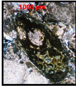
Esferulita con alteración avanzada de arcilla y óxidos e hidróxidos de Fe. Con forma de gota.
