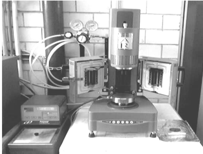
Figura 4.2. Reómetro de esfuerzos controlados (modelo AR2000)
