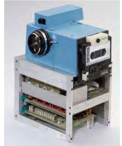
Primera cámara digital de la historia, 1975 desarrollada por Kodak y Steve J. Sasson. .01 megapíxeles y únicamente bco. y ngo.
