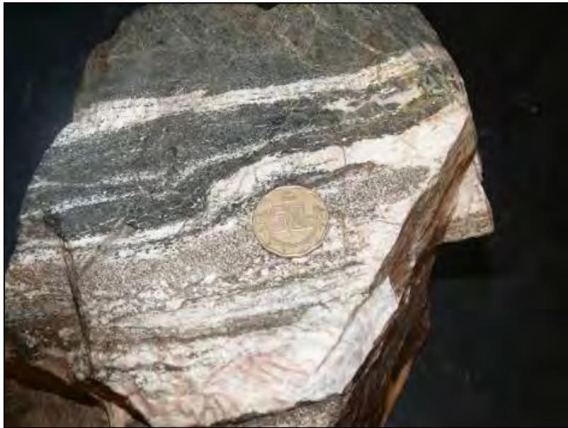
**Figura 12.** Detalle de anfibolita. Nótese sobreimpresión cataclástica en las bandas migmatíticas leucocráticas, las cuales son paralelas a la foliación primaria. Muestra proviene del afloramiento mostrado en **Figura 10**.
