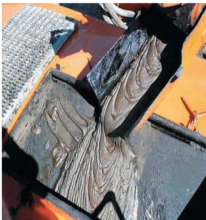
Figura 2.16 Lechada producida por el método de producción de crudo pesado con arena (CHOPS), ( Oilfield review , 2006, 18, 2).
