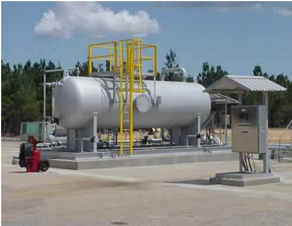
Figura 6.3 Separador bifásico horizontal (Francisco, R., 2000).
