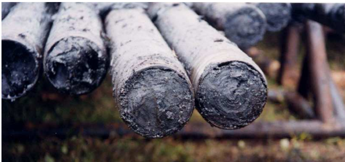
Figura 10.1 Tubería obstruida, (M-I SWACO 2009).
