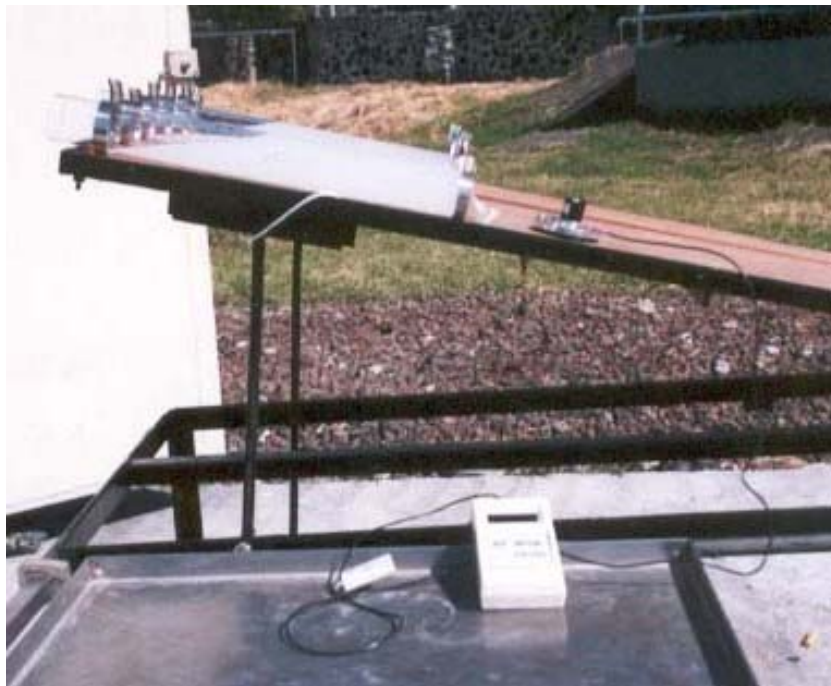
Figura 5. Colector plano y piranómetro en una de las pruebas experimentales
