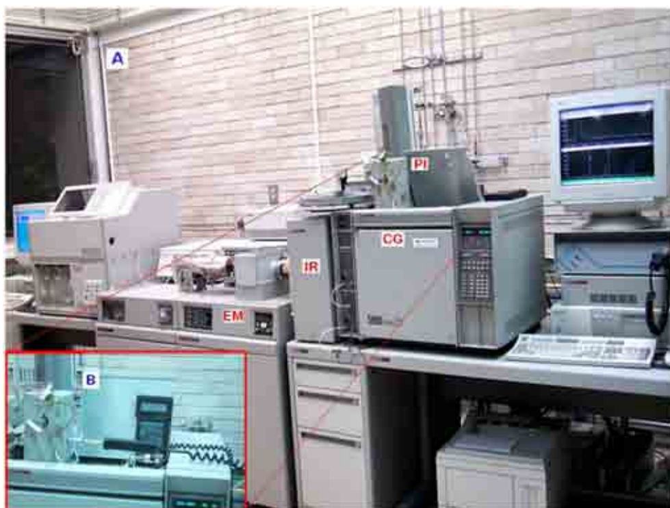
Figura 31. Equipo Acoplado de Análisis Pir-CG-EM. A) Sistema completo donde: PI: pirolizador CG: Cromatógrafo de Gases, IR: espectrofotómetro de infrarrojo; EM=espectrómetro de masas, B) Ampliación del pirolizador, donde se observa el controlador digital, la cámara de pirólisis y el sistema de inyección. Fotografía tomada de (Molina-Sevilla, 2005).
