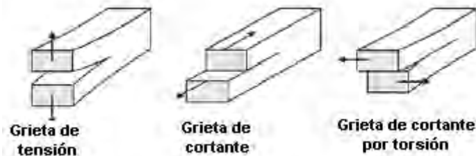
Figura 3.9 Modos de agrietamiento.
