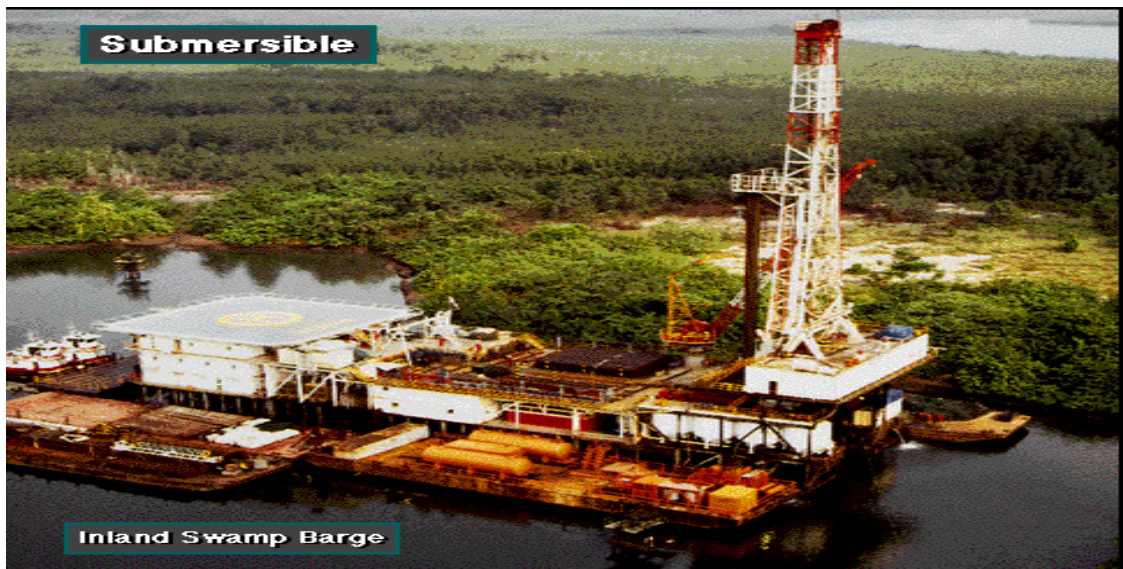
Figura 3. Plataforma Tipo Barcaza
