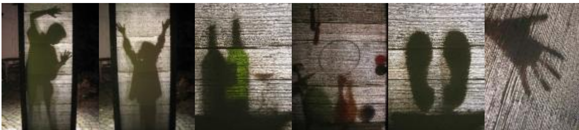
Fig. 5.4. En estas imágenes se puede observar como el concreto deja pasar la luz y los colores.
