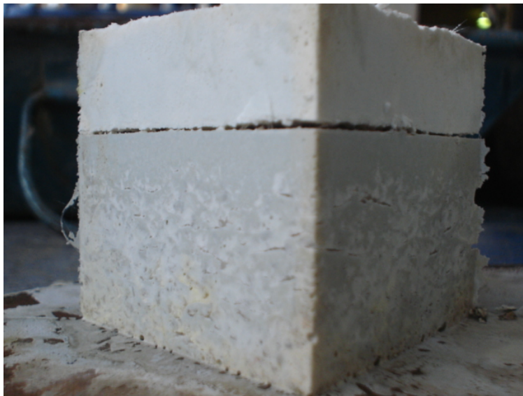
Fig. 5.13. Cubo de concreto producto de las pruebas para obtener concreto translucido.
