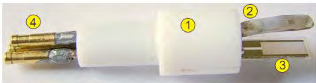
Fig.4. Esquema del electrodo acoplado 1) agarre de teflón, 2) contra electrodo 3) microelectrodo interdigital y 4) contactos
