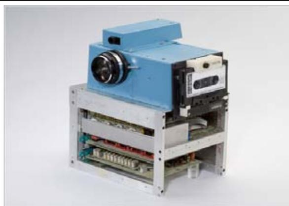
Ilustración 26: Prototipo de una de la cámara eléctrica creada desarrollada por Steve Sasson para Kodak.
