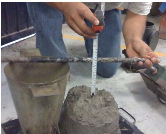
SE APISONA 25 VECES CON UNA VARILLA DE ACERO ESTÁNDAR DE 5/8" DE DIÁMETRO, REDONDEADA POR LA PUNTA Y LA SUPERFICIE SE VA NIVELANDO POR MEDIO DE MOVIMIENTOS LATERALES. DURANTE TODA LA OPERACIÓN SE DEBE DE MANTENER FIJO EL MOLDE SOBRE SU BASE.
