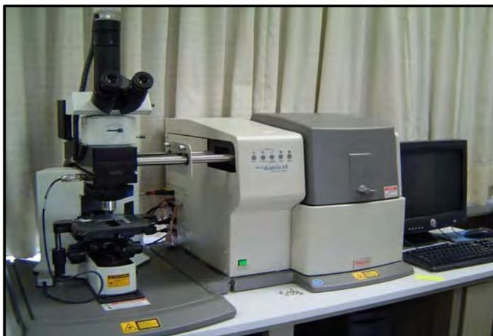
**Figura 9.** Espectrofotómetro Raman Dispersivo Nicolet Almega XR
