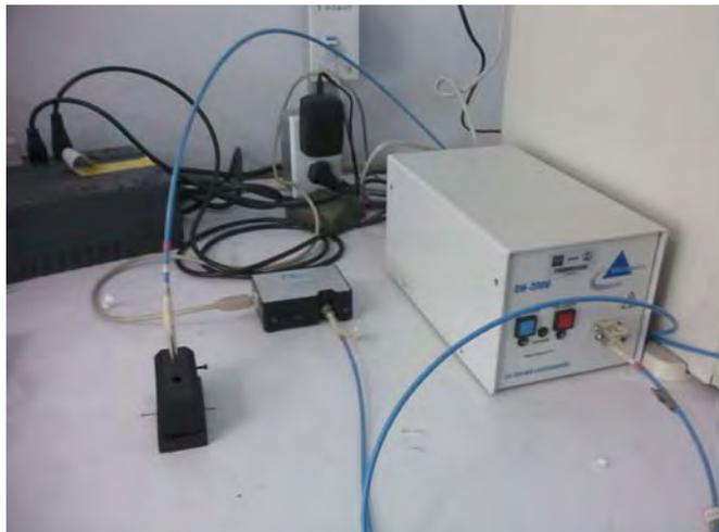
**Figura 12.** Espectrofotómetro Ocean Optics Modelo USB 2000
