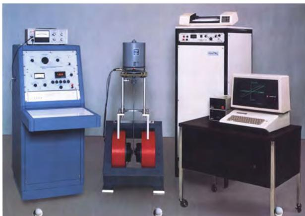
**Figura 13.** Magnetómetro de muestra vibrante, modelo LDJ 9600
