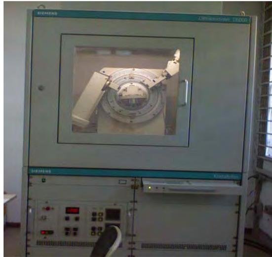
**Figura 10.** Difractómetro *Siemens* D5000
