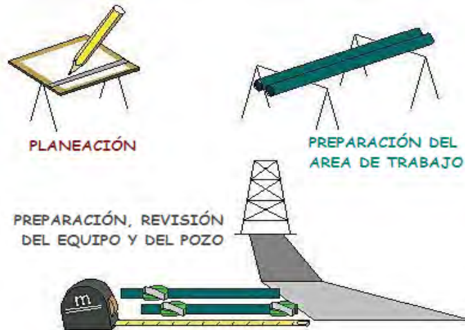
Figura 4.6. Etapas de las operaciones antes de empezar el muestreo.
