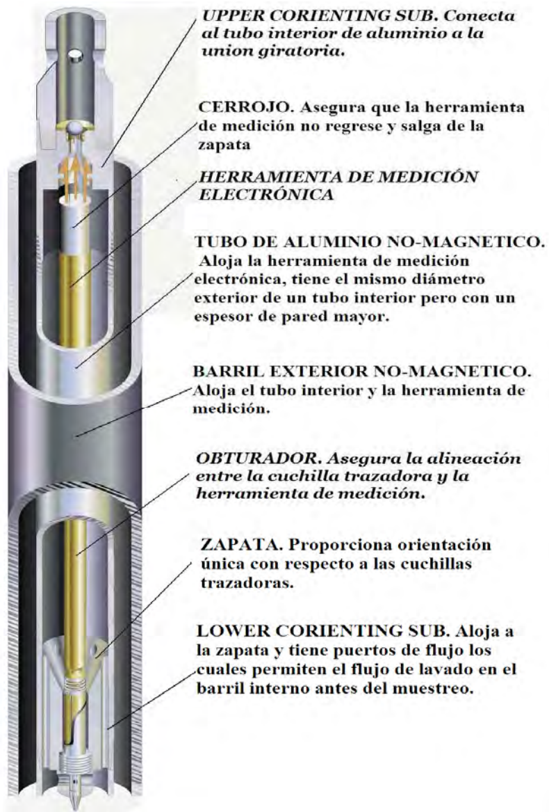
Figura 4.29. Partes internas esenciales del barril para corte de núcleo orientado.
