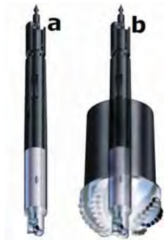
Figura 4.35. Tapón perforador solo y ensamblado.
