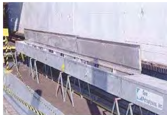
Cajas utilizadas para el congelamiento de los núcleos.
