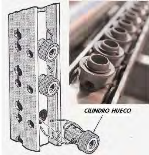
Figura 4.46. Muestra el cañón con la serie de pistolas con los cilindros donde se aloja la muestra.
