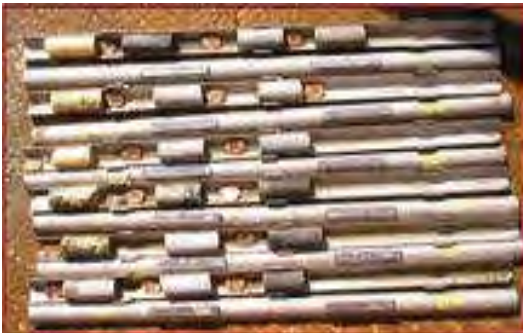
Figura 4.48. Muestras de núcleos de pared de pozo obtenidas por el método de rotación.
