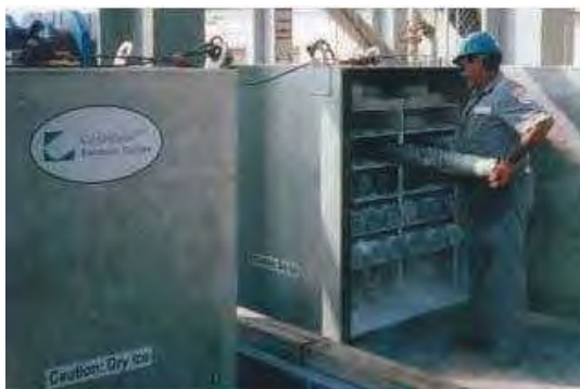
Caja utilizada para el transporte del núcleo hasta el laboratorio, con aislamiento térmico para conservar el hielo seco
