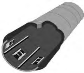
Figura 4.30. Atrapanúcleos orientado con tres marcadores de tungsteno de carbón.
