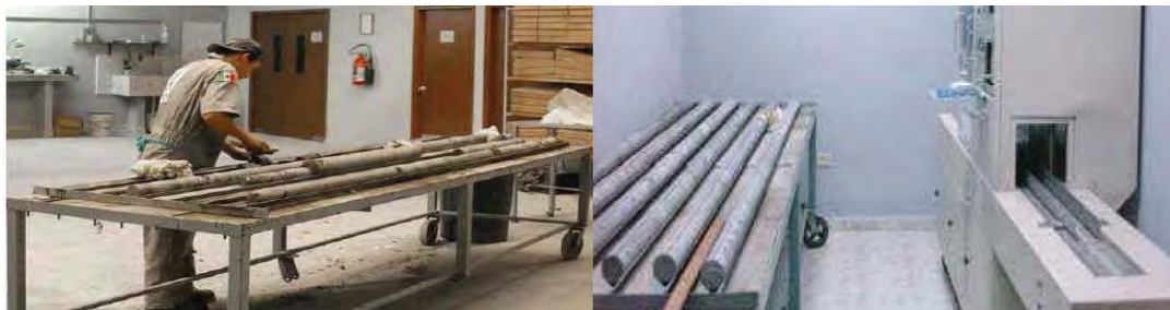
Figura 2.2. Mesa de trabajo para colocar, observar y seleccionar los núcleos en el laboratorio.
