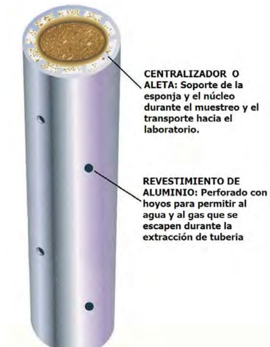
Figura 4.16. Sección del tubo de aluminio con esponja y núcleo.
