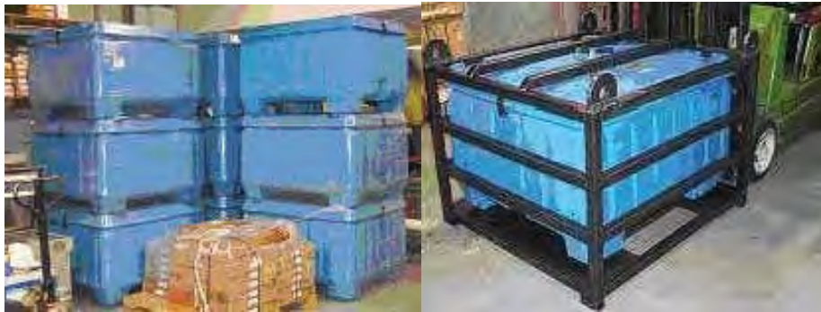
Figura 2.7. Estas cajas pueden ser utilizadas para transporte terrestre o puestas dentro de un armazón de hierro para transporte marítimo.
