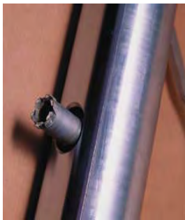
Figura 4.51. Pequeñas barrenas muestreadoras de pared de pozo.
