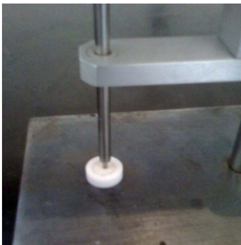
Figura 25. Determinación de los tiempos de fraguado indentación.
