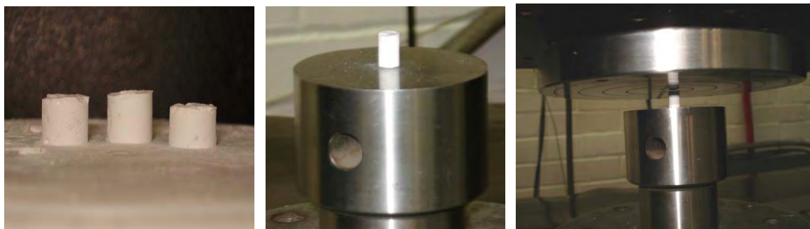
Figura 27. Probetas para ensayos de compresión. a) desmolde de probetas, b) probeta sobre la máquina instron, c) aplicación de carga.
