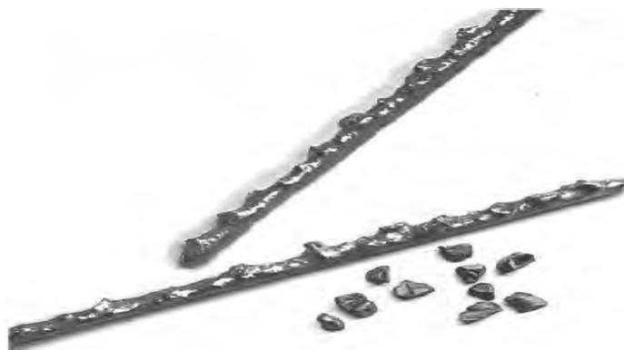
**Figura 3.13** Varillas de carburo de tungsteno, material usado para molinos y zapatas.
