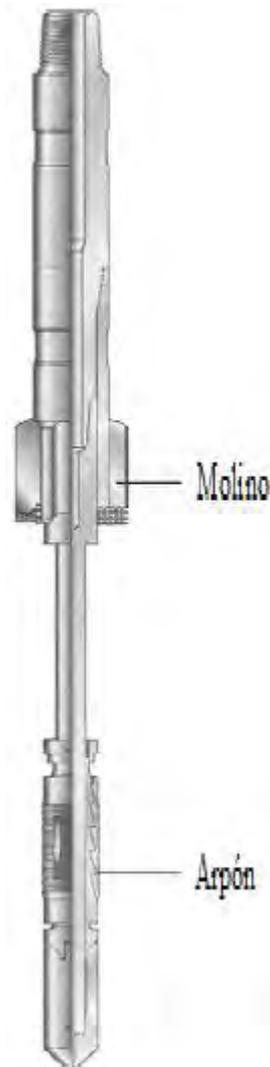
**Figura 1.5** Herramienta para recuperar empacador con molino y arpón.
