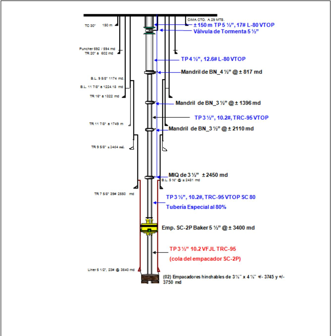
Diagrama de la Tubería pegada
