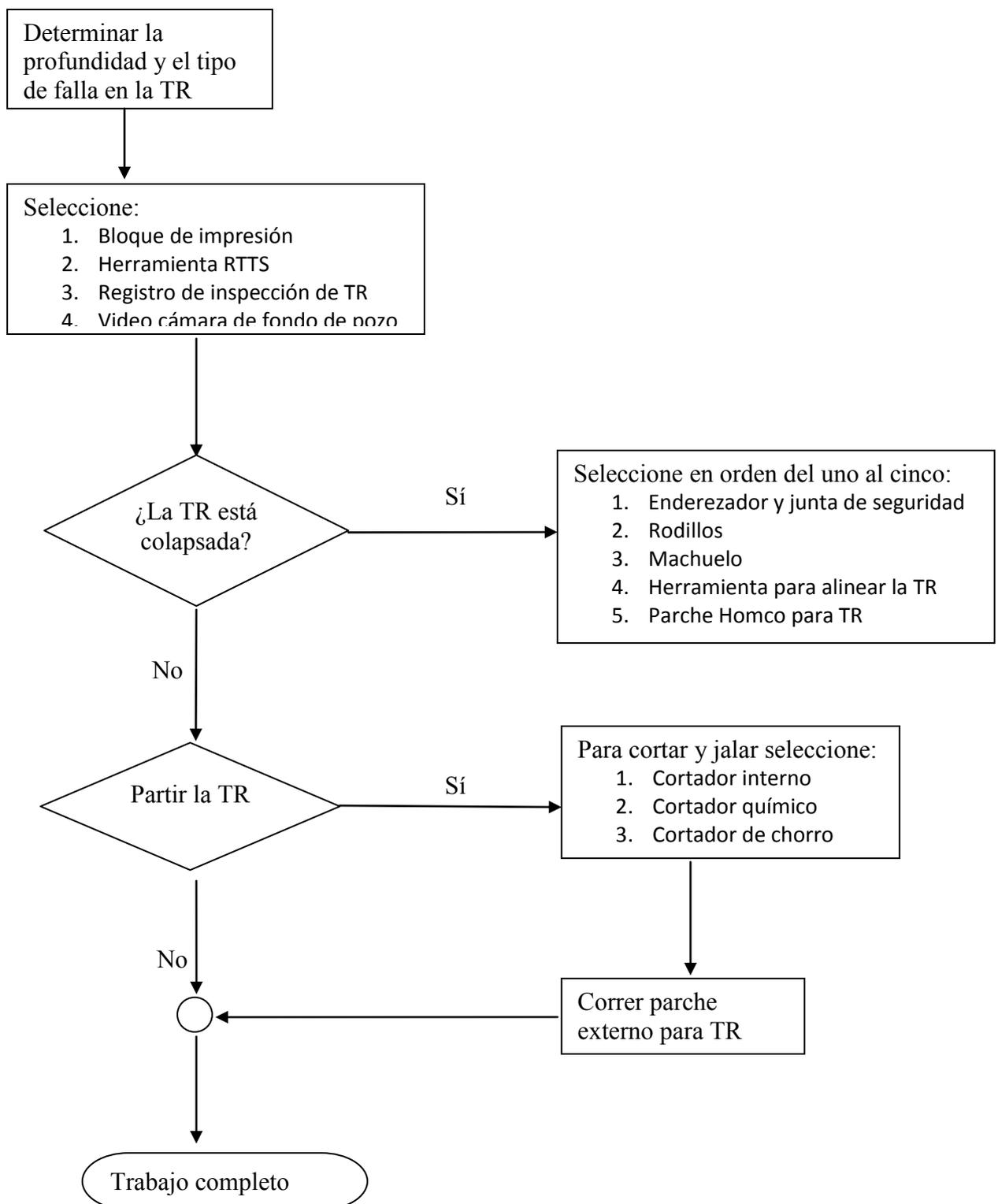
**Figura 1.7** Diagrama de flujo para determinar problemas en la TR y sus posibles soluciones.
