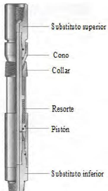
**Figura B.4** Tubería de anclaje hidromecánica, elimina el movimiento de la tubería flexible
