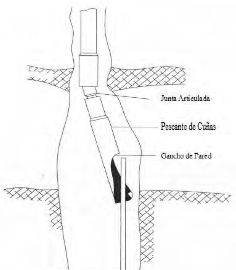
**Figura 1.6** Pesca en cavidades con gancho de pared, junta articulada y pescante de cuñas.
