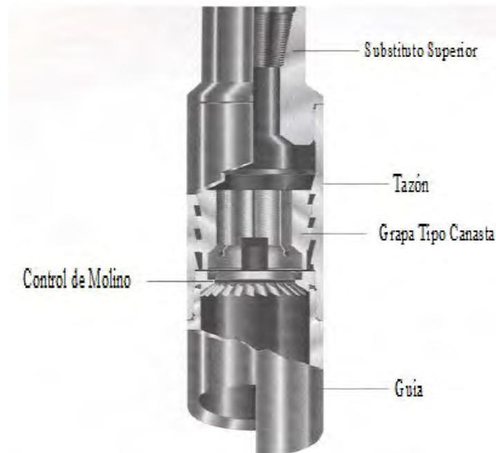
Pescante de cuñas acondicionado con grapa tipo canasta, usado para engranar externamente el pescado.
