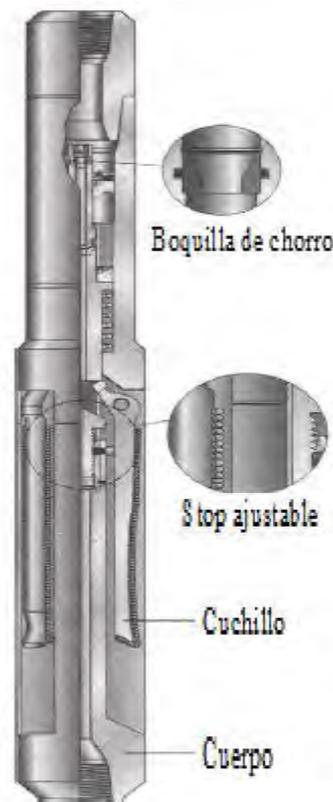
**Figura 1.13** Cortador para múltiple sarta de tubería de revestimiento
