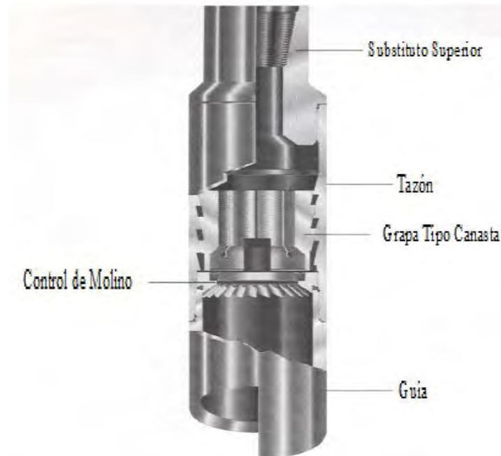
**Figura 3.1** Pescante de cuñas acondicionado con grapa tipo canasta, usado para engranar externamente el pescado.
