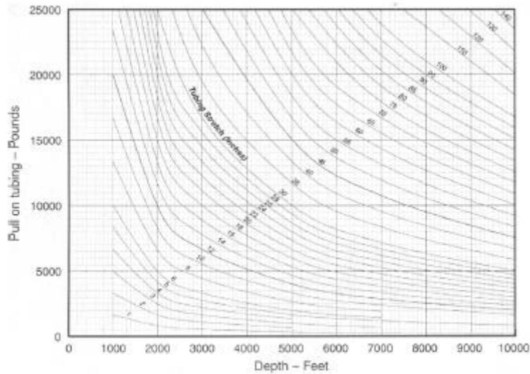
**Figura 4.1** Grafica de elasticidad, para tubería de 1.660 pg. de diámetro exterior y un peso de 2.4 lbs./ft.
