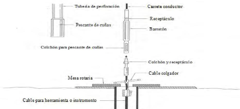
**Figura A.1** Equipo y herramientas utilizadas en el método cable guía.
