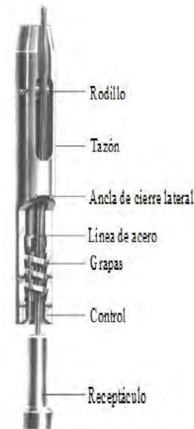
**Figura A.2** Pescante de cuñas de cierre lateral, permite que la línea entre en la herramienta.
