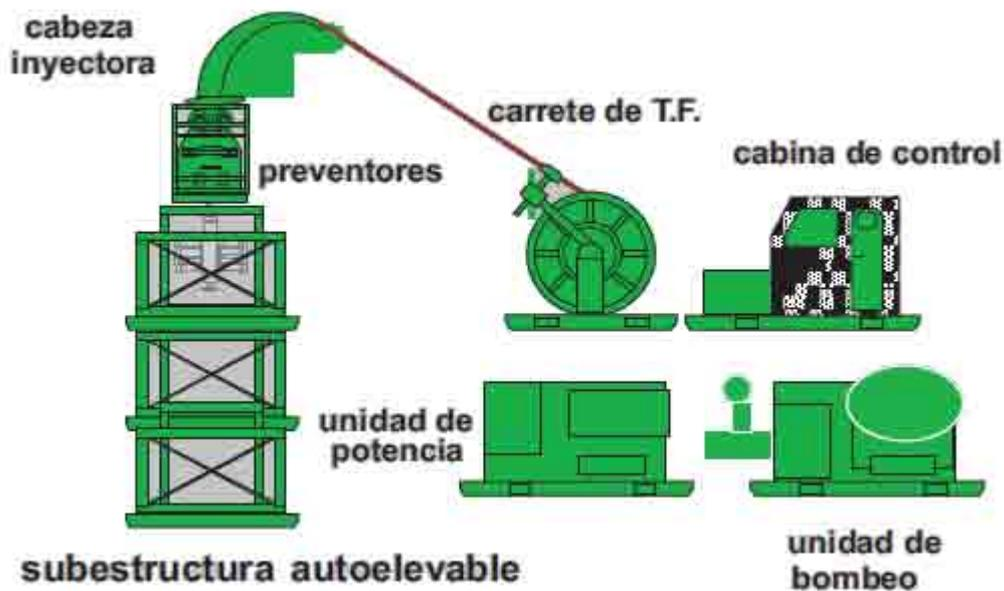
**Figura B.1** Diagrama de tubería flexible
