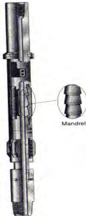
**Figura 1.12** Arpón, para recuperar la tubería de revestimiento.
