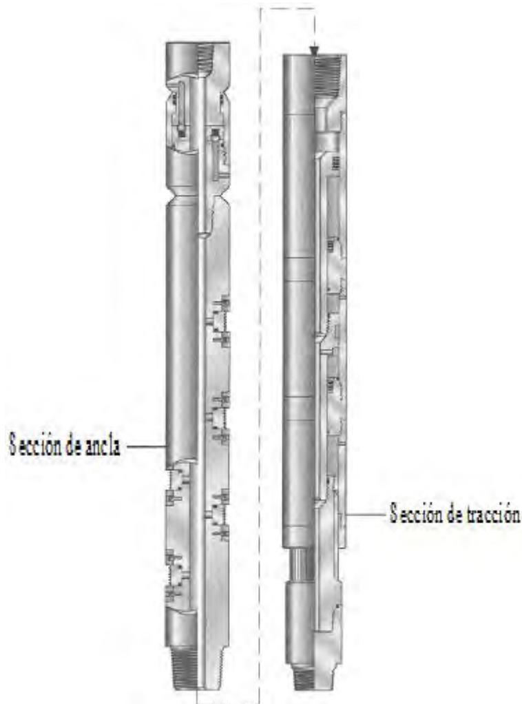
**Figura 3.20** Herramienta de tracción hidráulica, utiliza presión de bombeo hidráulico para sacar objetos del agujero.
