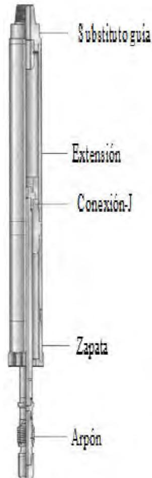
**Figura 1.4** Herramienta para recuperar empacador permanente con molino o extensión.
