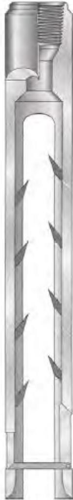
**Figura A.4** Arpón con dos puntas de agarre, se utiliza para pescar la línea dentro de la tubería.
