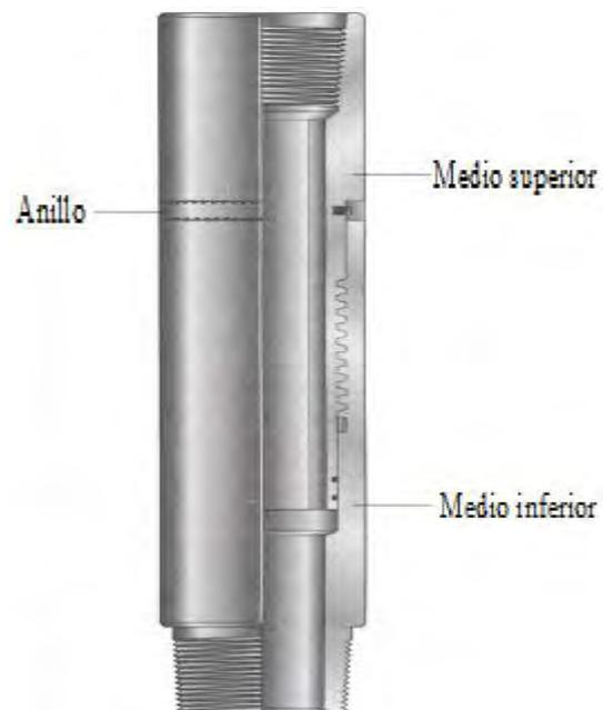
**Figura 3.23** Junta de seguridad de perforación, permite desconectar la sarta de la tubería.
