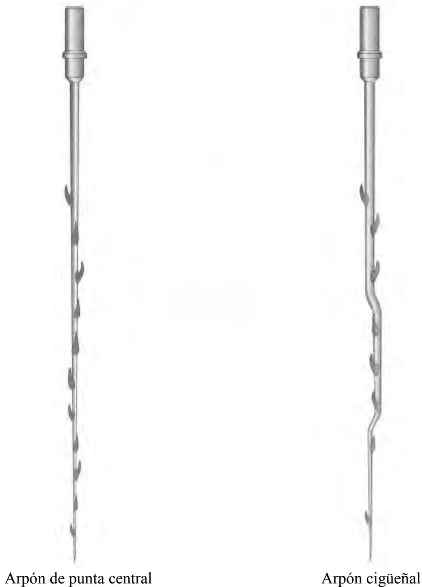
**Figura A.3** Diferentes tipos de arpones para recuperar línea de acero que esta separada.
