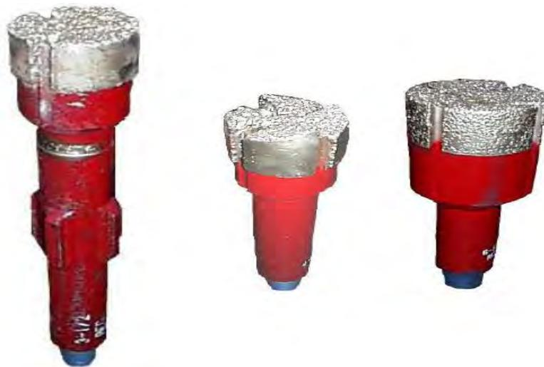
**Figura 3.16** Molinos con diferentes configuraciones de fondo (plano, cóncavo y cónico de aletas).
