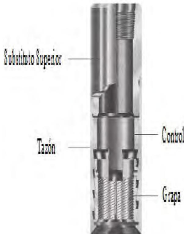
**Figura 3.4** Pescante de cuñas con agarre cortó para ser usado cuando la parte expuesta del pescado es demasiado corta.
