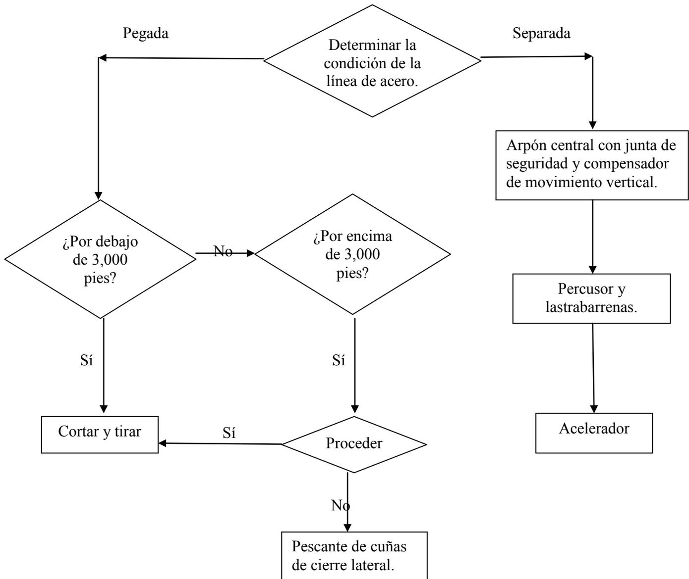
Figura A.5 Diagrama de flujo para pesca de línea de acero en agujero abierto.
