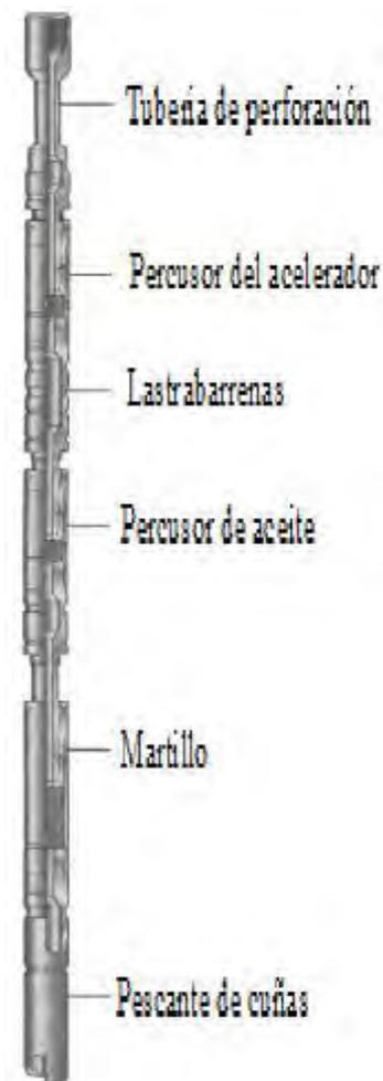
**Figura 3.8** Típica sarta de vibración, ayuda a sacar el pescado y liberar la herramienta de captura.
