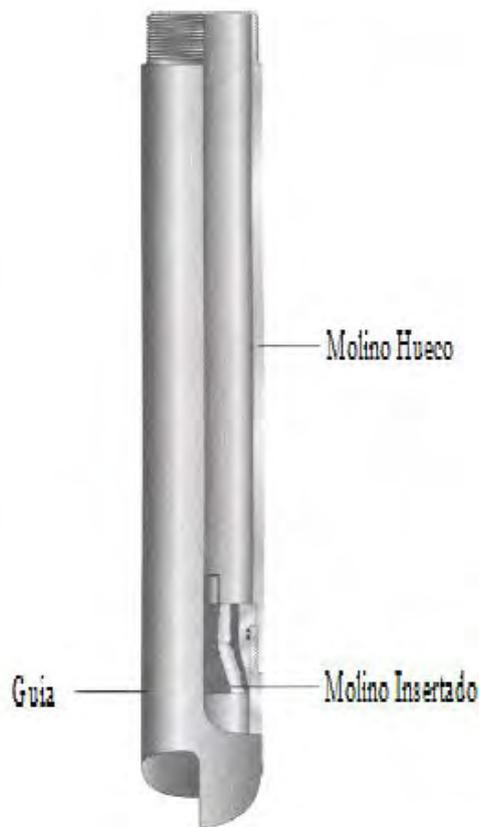
Extensión inferior con molino, se monta en el pescante de cuñas para moler la tubería.
