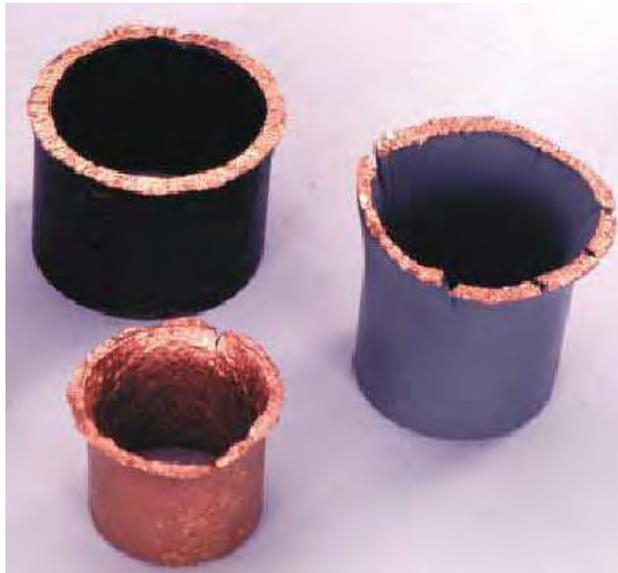
Ejemplo de tubería cortada con cortador de chorro.
