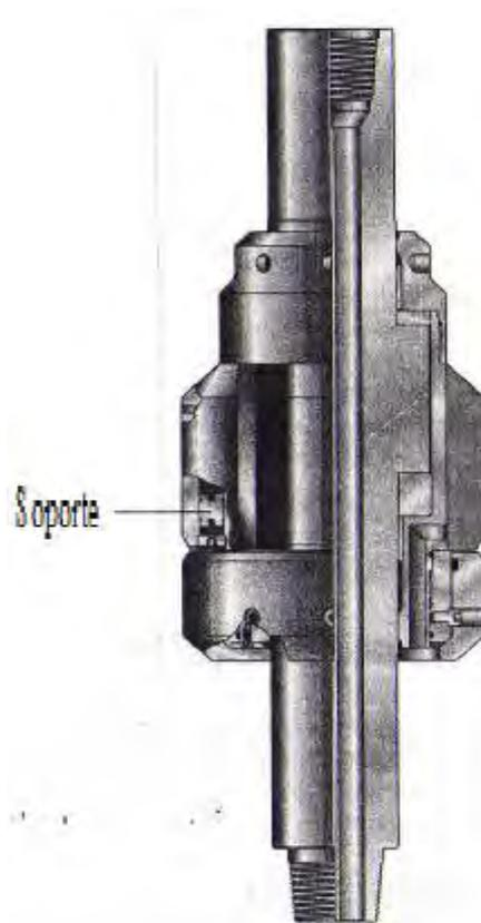
**Figura 1.14** Cabeza giratoria marina, ayuda a mantener estabilizados a los cortadores de tubería de revestimiento.
