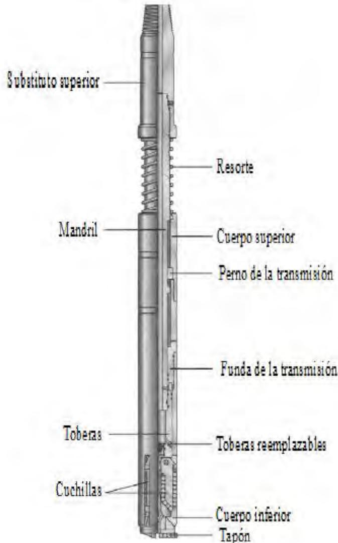
**Figura B.3** Tubería de corte hidromecánica, corta tubería de dimensiones y material comunes.
