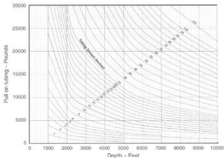
**Figura 4.2** Grafica de elasticidad, para tubería de 1.900 pg. de diámetro exterior y un peso de 2.9 lbs./ft.
