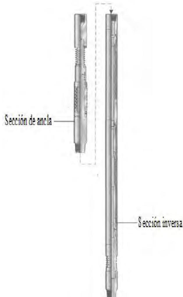
**Figura 3.19** Herramienta inversa, recupera y desenrosca secciones de tubería o herramientas pegadas.
