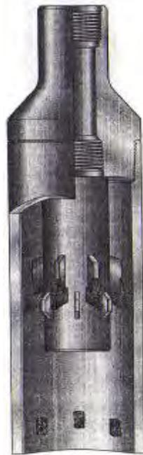
**Figura 1.9** Herramienta para acondicionar la tubería de revestimiento
