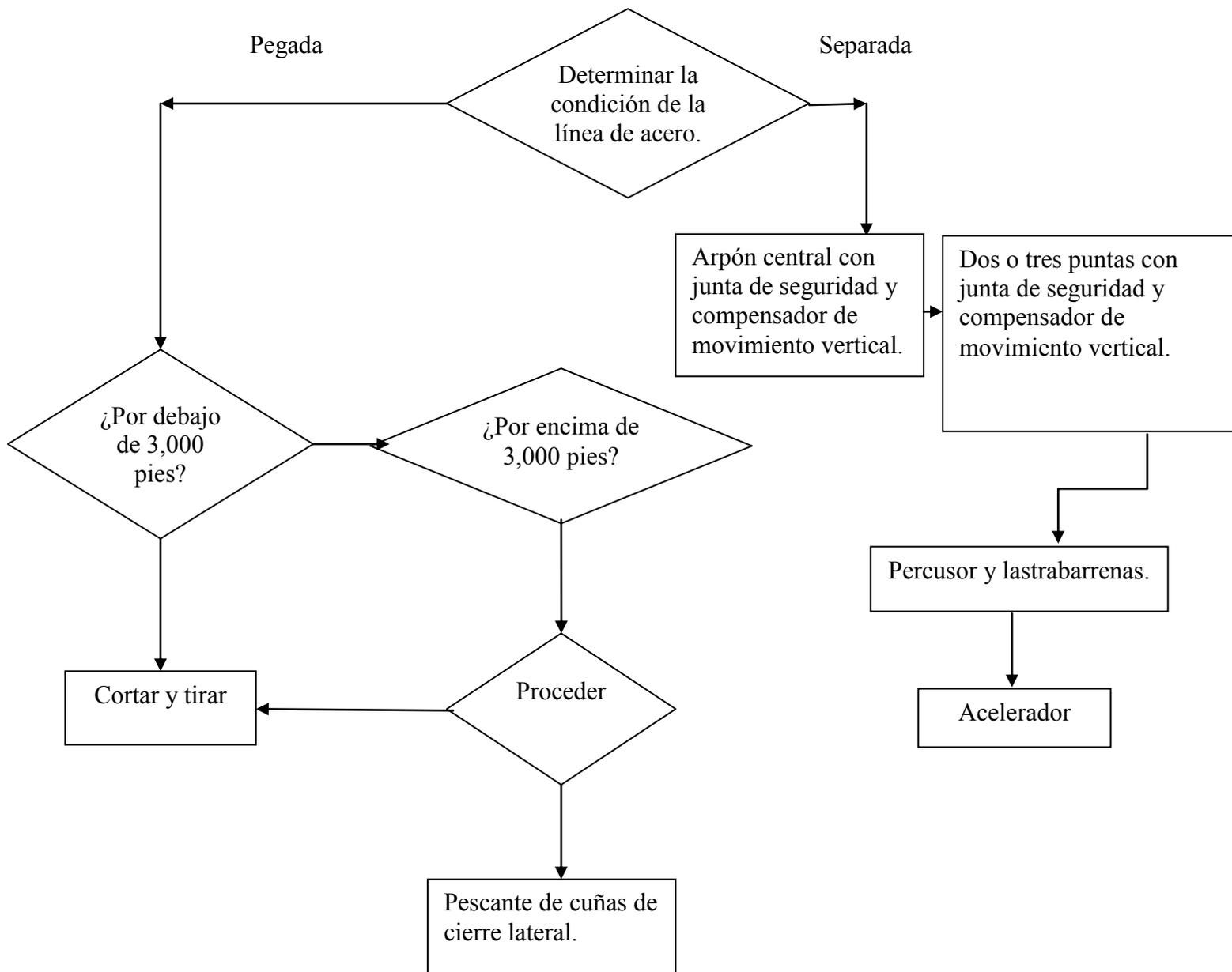
Figura A.5 Diagrama de flujo para pesca de línea de acero en agujero entubado.
