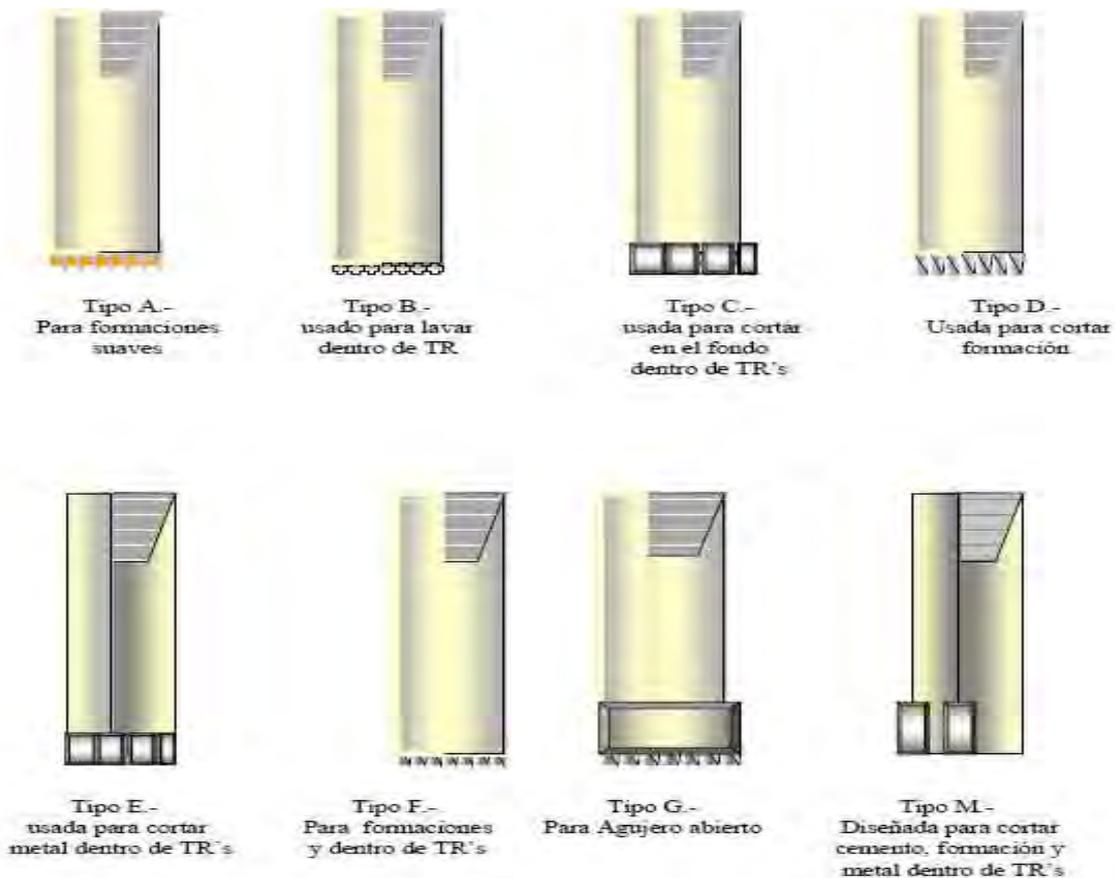
**Figura 3.15** Diferentes tipos de zapatas lavadoras, dependiendo de la necesidad del lavado y del pescado.
