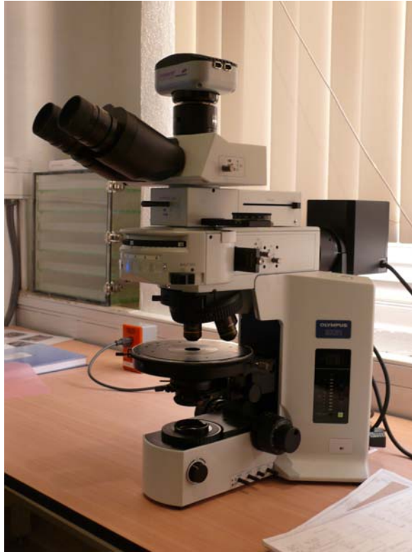
Figura 2.2: Fotografía del microscopio petrográfico de polarización Olympus BX-51 utilizado en este estudio (Laboratorio de Geofluidos, CGEO, UNAM).
