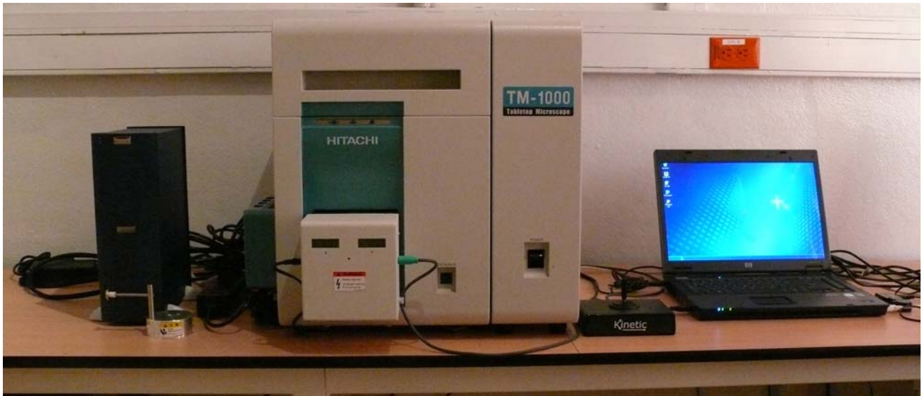
Figura 2.7: Fotografía del microscopio electrónico Hitachi TM-1000. Procesador de datos para EDS (izquierda), aparato SEM, (centro derecha) controlador digital de la platina con movimiento X-Y (centro izquierda), computadora controladora (derecha).
