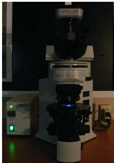
Figura 2.3: Fotografía del microscopio de fluorescencia UV Olympus BH2 con lámpara de mercurio (izquierda) y filtro para luz ultravioleta, utilizado en este estudio (Laboratorio de Geofluidos, CGEO, UNAM).
