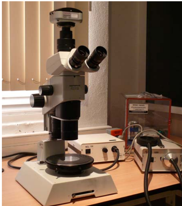
Figura 2.1: Fotografía del microscopio binocular Olympus SZX-12 utilizado en este estudio (Laboratorio de Geofluidos, CGEO, UNAM).
