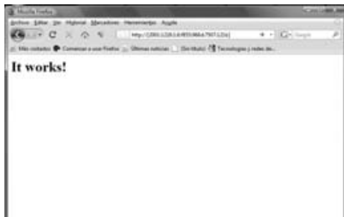
Figura 8.7 Prueba de conexión al servidor Web en Windows Vista a través del navegador Firefox.
