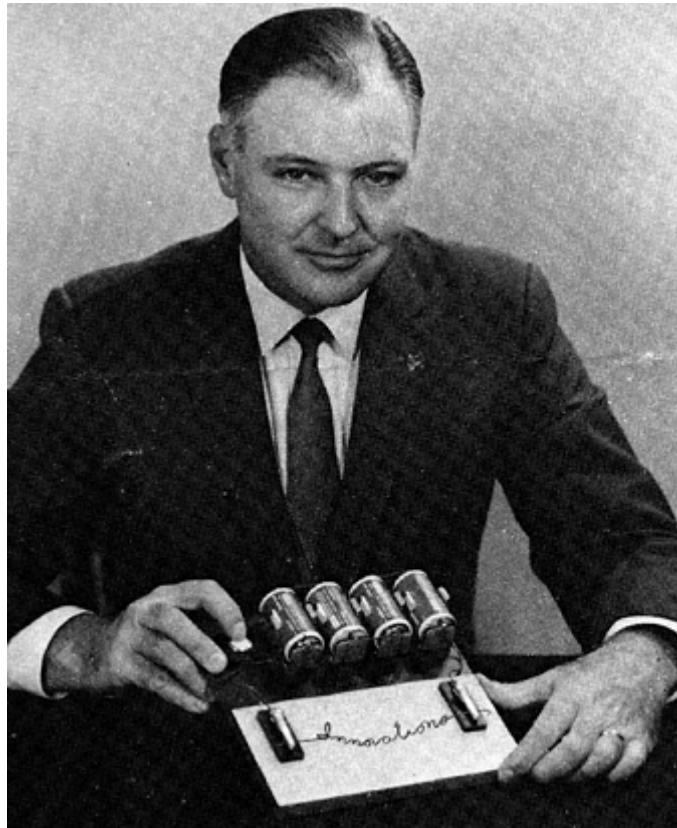
FIG. 1 WILLIAM J. BUEHLER EN 1968. EN LA FOTO CON UNA DEMOSTRACIÓN DE ALAMBRE DE NITINOL. LA ELECTRICIDAD SE HACE PASAR POR UNA PIEZA DE ALAMBRE RECTO Y EL ALAMBRE CAMBIARIA EN LA PALABRA "INNOVATIONS". THE OAK LEAF, U.S. NAVAL ORDNANCE LABORATORY, WHITE OAK, MARYLAND, JUNIO DE 1968.
