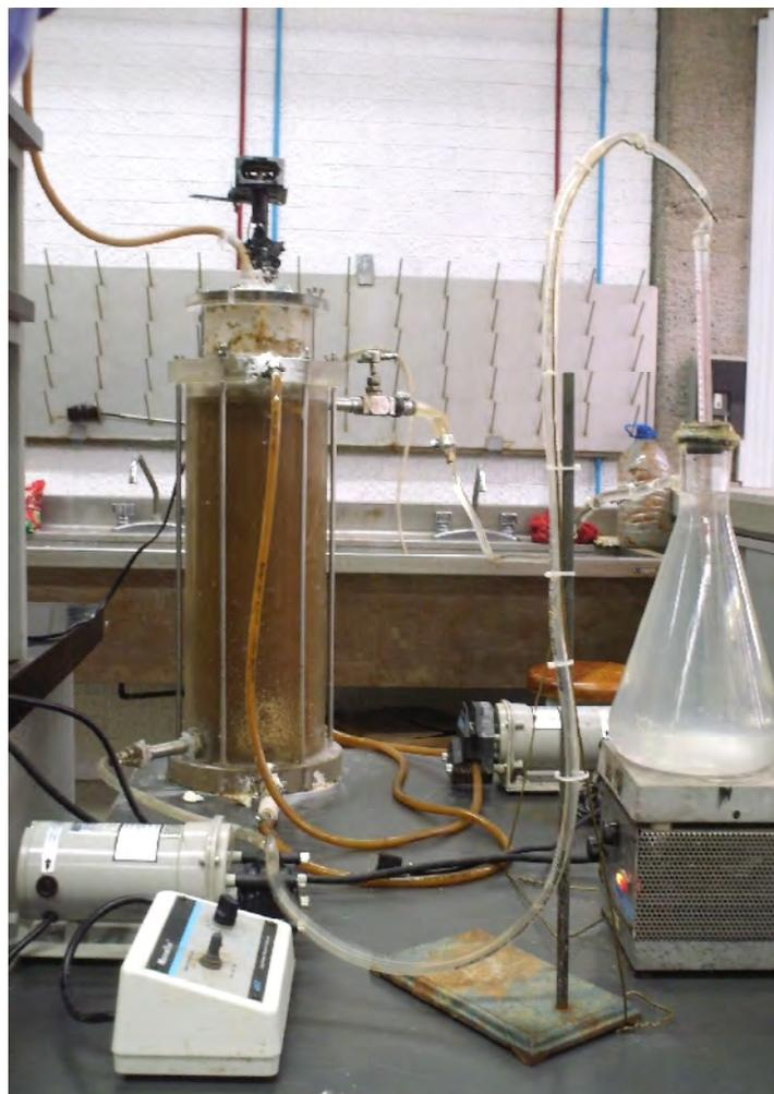
Figura 3.2 Reactor fermentador de 5L
