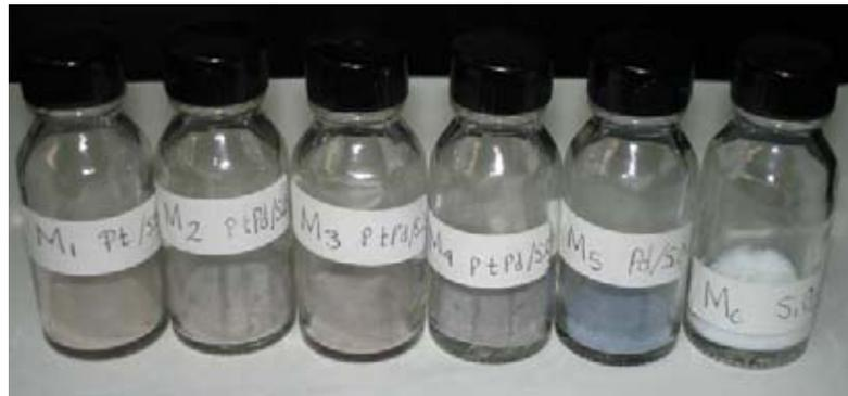
Figura 4.2 Muestras de  $\text{Pt}_x\text{-Pd}_{1-x}$  soportadas en  $\text{SiO}_2$  después de la impregnación y el secado.
