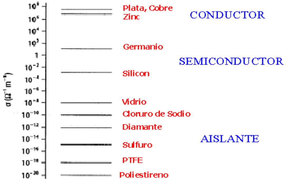
Figura 1.5 Escala comparativa de la conductividad en diferentes tipos de materiales.
