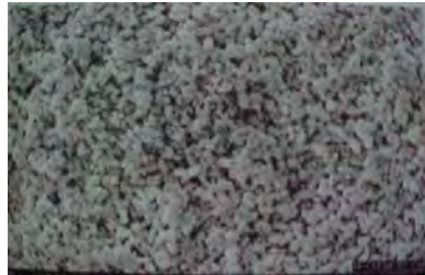
Fig. 11 Partículas de zirconia de una estructura sin sinterizar. 7
