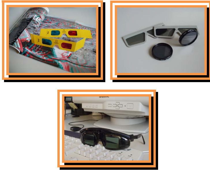
Ejemplos de sistemas de visión estereoscópica: anaglifos, lentes polarizadas y gafas obturadoras. 103,104
