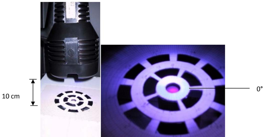
**Figura 6.7 Plantilla para la obtención del espectro de la lámpara**
