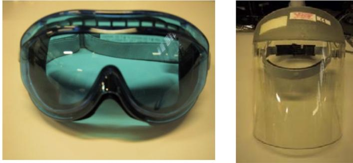
**Figura 2.3.1. Lentes y careta para el manejo de radiación ultravioleta**
