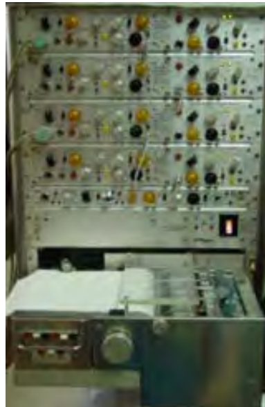
Fig.8 Electromiógrafo GRASS MODEL 79D
