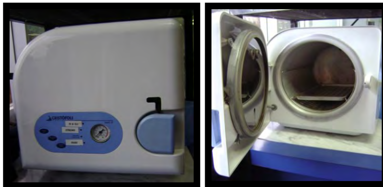
Figura 13. Vista interior y exterior del autoclave 52
