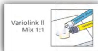
Mezclar el cemento adhesivo
