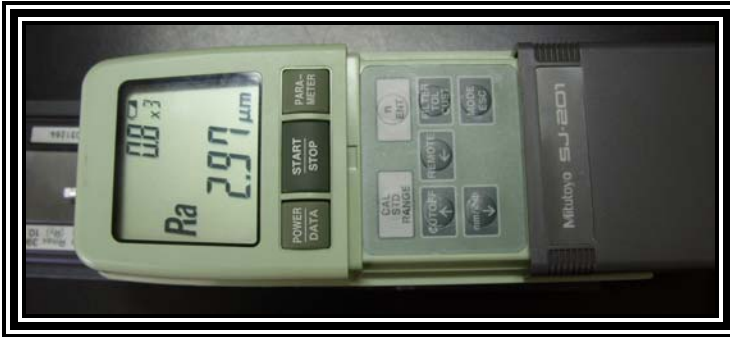
Figura 15: Perfilómetro, instrumento que ofrece la posibilidad de calcular la rugosidad superficial de cualquier material.
