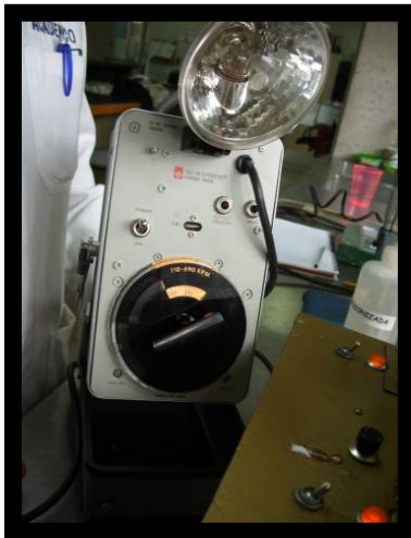
Figura 3: Estroboscopio, instrumento utilizado para tomar la medida de los ciclos al que se expuso cada muestra.
