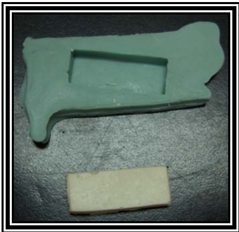
Figura 13: muestra delimitada con un molde de silicona pesada marca ULTRASIL dándonos un positivo de 25 milímetros de largo por 10 milímetros de ancho por 4 milímetros de espesor.
