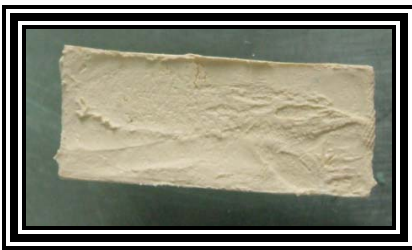
Figura 1: Muestra obtenida del molde de silicón con 25 milímetros de largo por 10 milímetros de ancho por 4 milímetros de espesor
