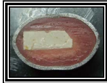
Figura 2: Muestra embebida en acrílico en un molde metálico
