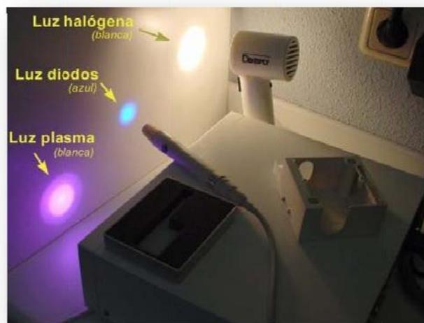
Fig.2 Luz emitida por diferentes lámparas de fotopolimerizar.
