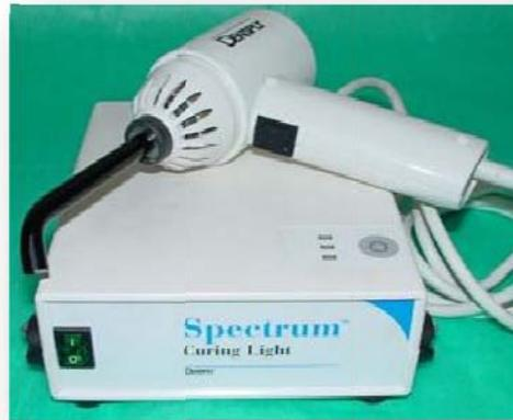
Fig.4 Halógena convencional
