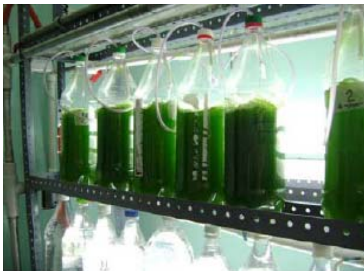
Foto 2. Scenedesmus acutus cultivada con aguas residuales en condiciones de laboratorio
