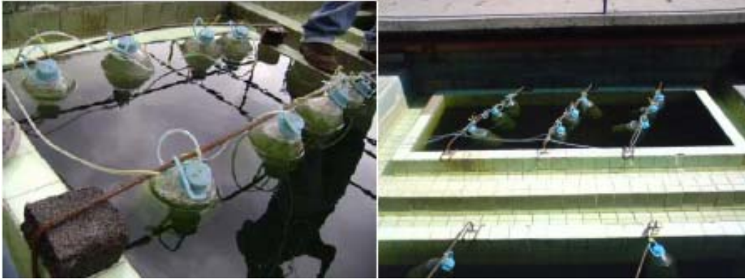
Foto 4. Microcosmos instalados en la planta de tratamiento El Rosario para los experimentos realizados en campo.
