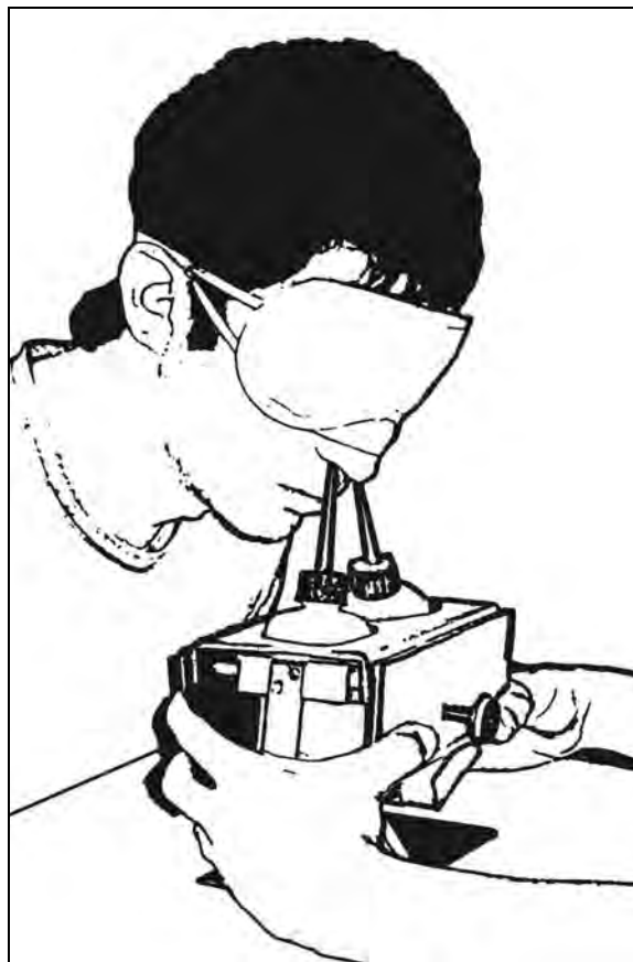
Figura 5. Aparato que permitía que se suministrara un volumen constante de aire en cada fosa nasal. Se estimularon ambos lados de la nariz de manera independiente pero simultáneamente durante la misma inhalación. La tarea del sujeto era identificar la fosa nasal que recibía el estímulo de eucaliptol.
